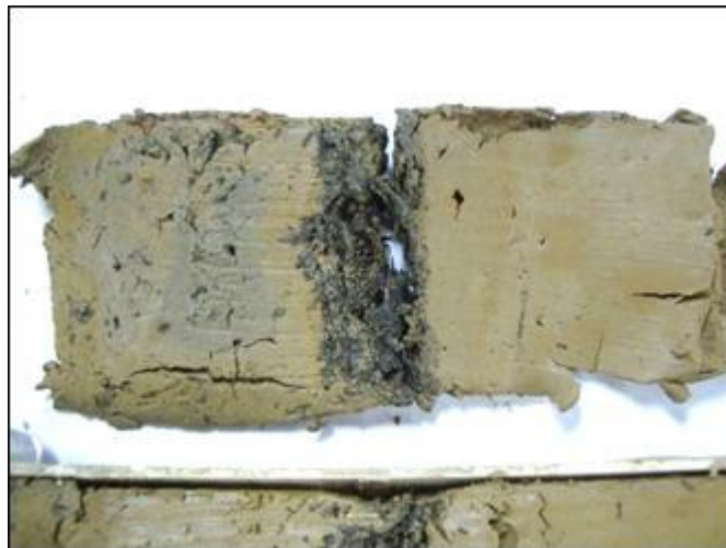
Figura 50 - Pedacos de material orgânico entre camada de sedimento da seção 0-38 cm do testemunho do furo F2 (Foto: Marcondes Lima da Costa).
