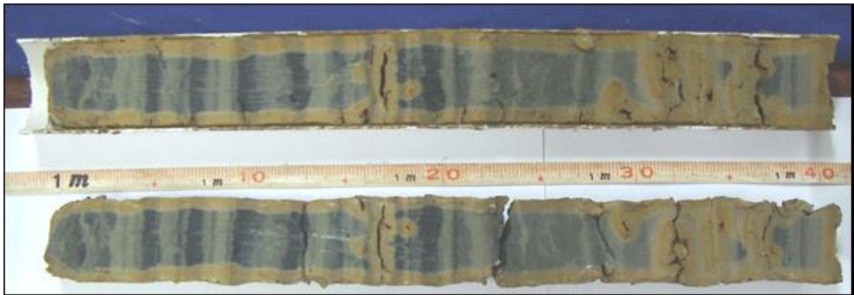
Figura 48 - Aspecto dos sedimentos de fundo do lago Amapá, mostrando o bandamento característico dado pela alternância de camadas claras e escuras afetadas pela oxidação, ao serem expostos ao ambiente, denotada pela cor marrom na periferia dos testemunhos. Detalhe da seção 100-140 cm do furo LAPF1 (Foto: Marcondes Lima da Costa).
