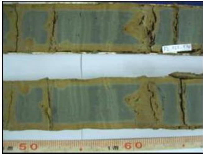
Figura 49 - Detalhe da seção 148-167 cm do furo F2, com microlaminação de camadas claras e escuras (Foto: Marcondes Lima da Costa).
