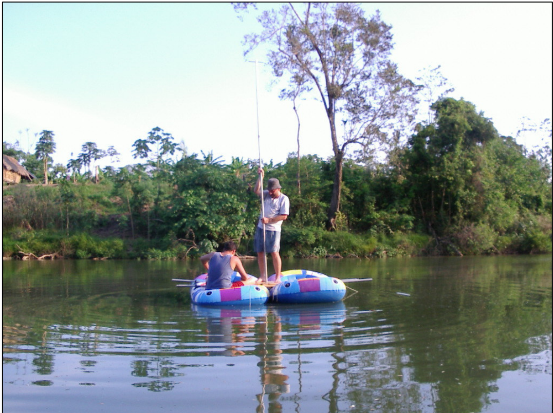
Figura 13 - Sondagem com auxílio de sonda manual tipo Livingstone para coleta de sedimento de fundo na estação LAPF1 do lago Amapá (Foto: Marcondes Lima da Costa).
