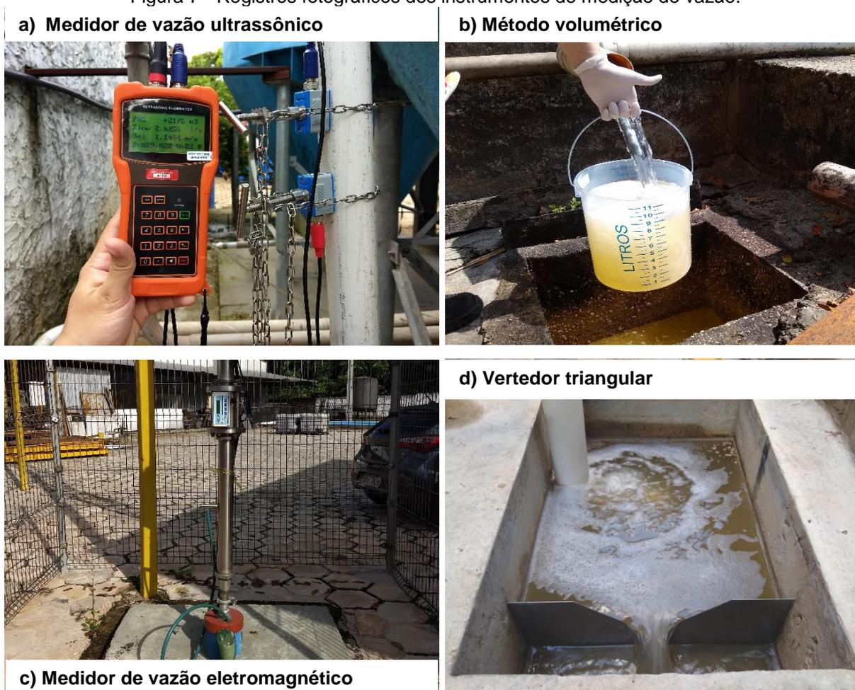
Conforme o Quadro 7, neste trabalho, foram utilizados 4 métodos de medição direta de vazão para quantificar a massa líquida nos pontos de consumo de água identificados. Entretanto, também, foram adotados métodos indiretos de quantificação
