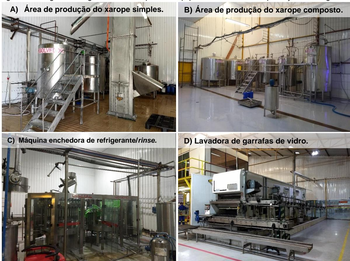
Não foram identificadas tubulações, juntas ou válvulas com vazamentos de água, pois elas encontram-se em bom estado de conservação. Entretanto, foi verificado que os conjuntos moto-bomba presentes na etapa de envase da bebida apresentam, constantemente, problemas com vazamentos de água pelo selo de proteção do equipamento. Tais problemas, quando identificados, são reparados no momento em que há a paralização das atividades de produção do refrigerante, exceto
