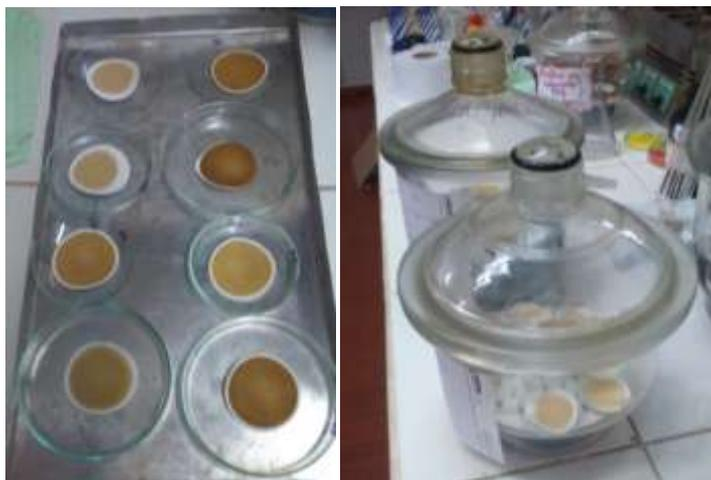
**Figura 33** – Amostras nas lâminas de vidro ao saírem da estufa e amostras no dessecador.
