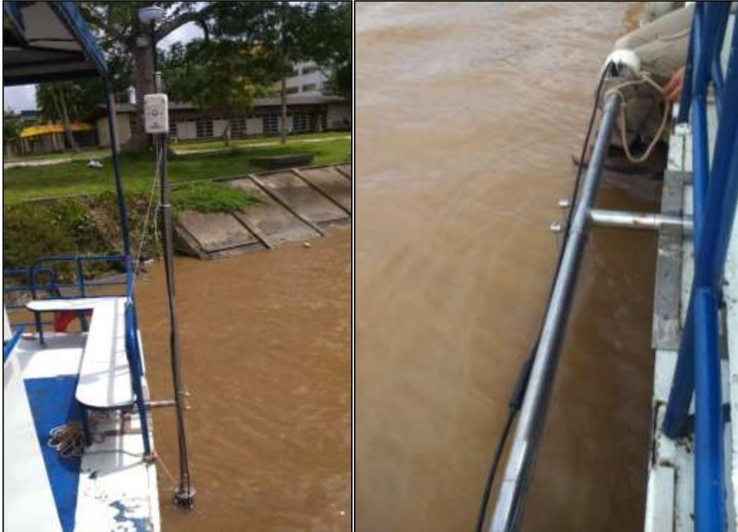
**Figura 19** - ADCP instalado na embarcação.
