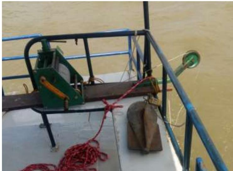
**Figura 24** - Guincho Hidrométrico.
