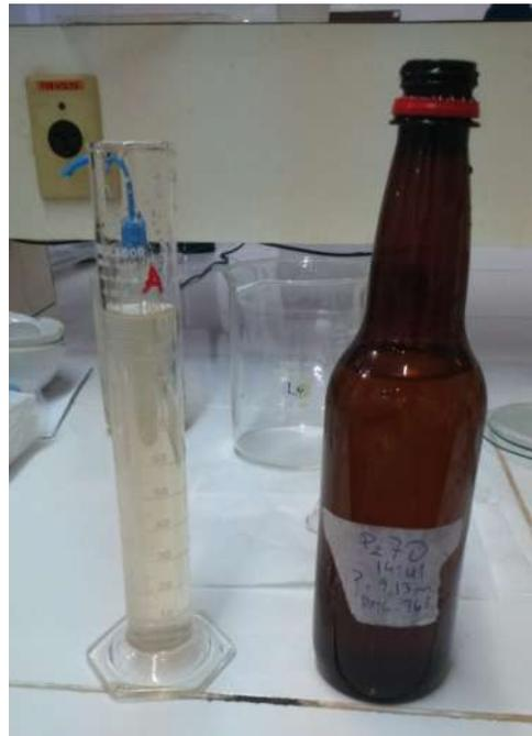
**Figura 31** - Proveta com 100 ml de amostra e garrafa plástica utilizada na pesquisa.
