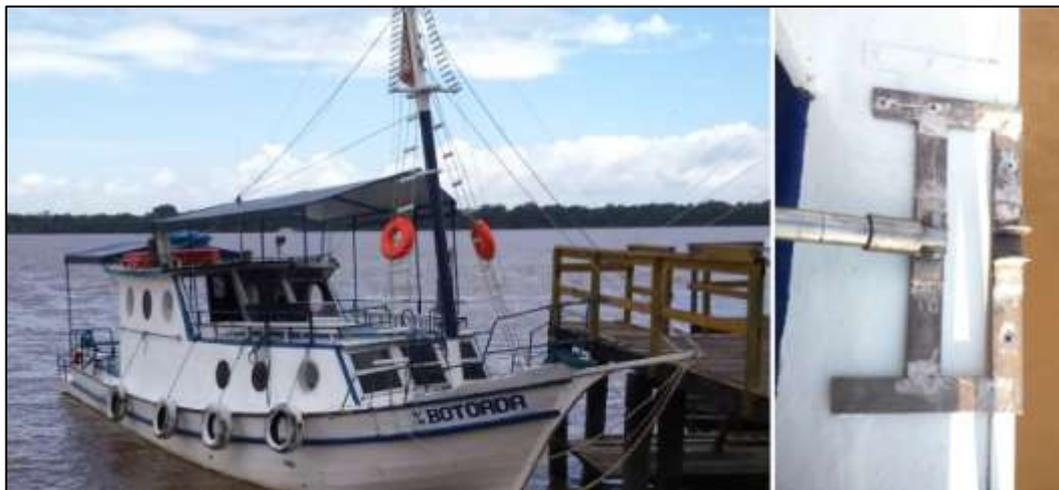
**Figura 18** - Barco utilizado na pesquisa e suporte para o ADCP.
