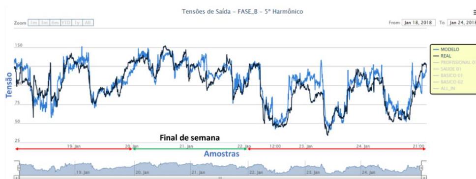
Figura 5-14 – Comparação dos valores de tensão harmônica de 5ª ordem obtidas via medição (preto) com os valores estimados pelo modelo neural (azul), para fase C
