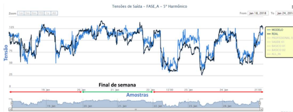
Figura 5-12 – Comparação dos valores de tensão harmônica de 5ª ordem obtidas via medição (preto) com os valores estimados pelo modelo neural (azul), para fase A
