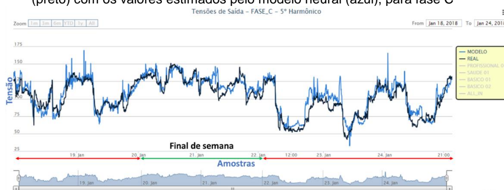
Figura 5-14 – Comparação dos valores de tensão harmônica de 5ª ordem obtidas via medição (preto) com os valores estimados pelo modelo neural (azul), para fase C
