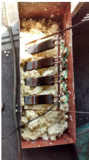
Figura 16 – sistema para dissolução do sebo bovino.
