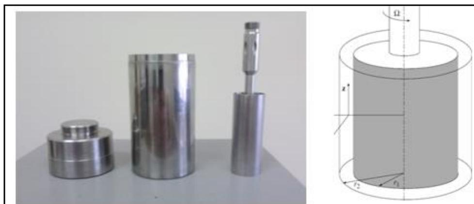
Figura 3.14 - Sistema de medição de viscosidade aparente copo SV e *Spindle* SV1.
