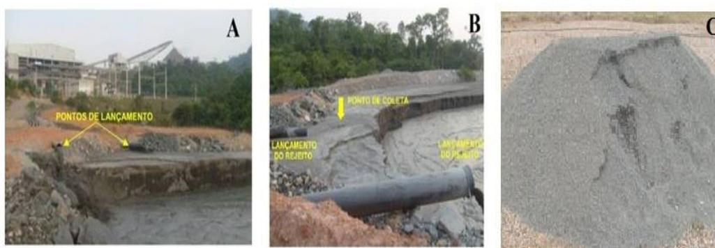
Figura 3.8 - Vista do ponto de lançamento do resíduo de minério de cobre (A), ponto de coleta do material (B) e material coletado (C). Fonte: MULLER e CASTRO FILHO, (2008).
