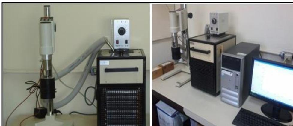
Figura 3.13 - Viscosímetro VT 550 acoplado ao banho térmico.
