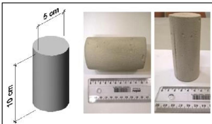
Figura 3.9 - Modelo e dimensão dos corpos de prova Elaborados na pesquisa.
