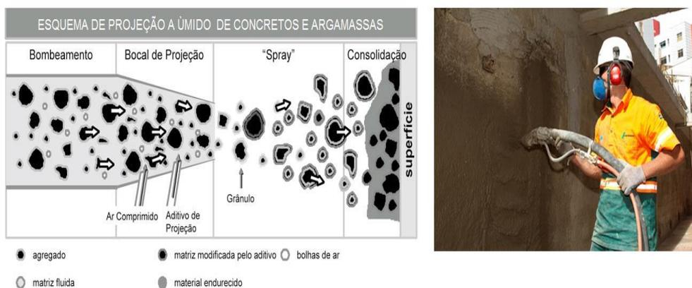
Figura 2.18 - Ilustração esquemática da aplicação de materiais cimentícios com destaque dos quatro aspectos da técnica (a) bombeamento; (b) bocal de projeção; (c) spray e (d) consolidação. Fonte: D. VASQUES FILHO, (2004).
