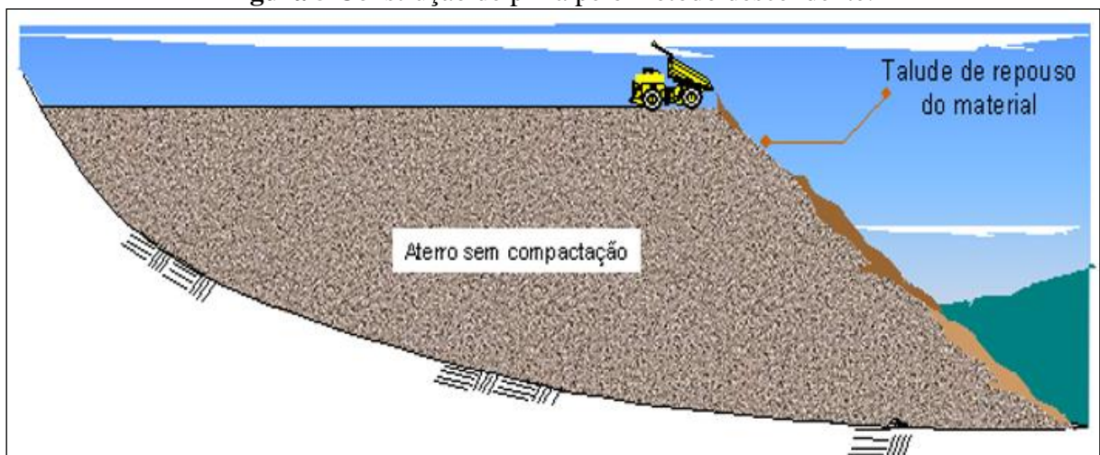
Figura 5 Construção de pilha pelo método descendente.
