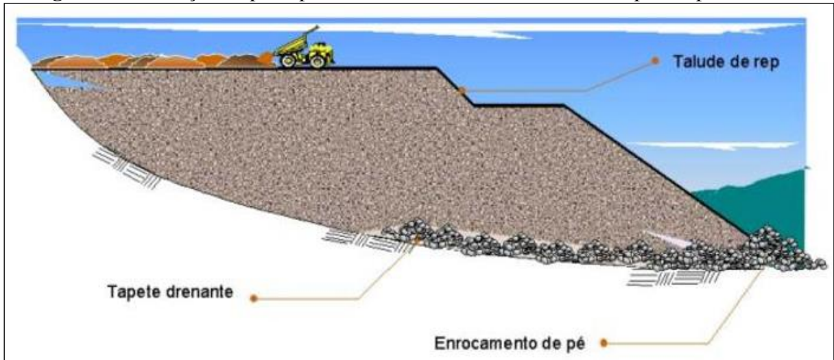
Figura 6 Construção de pilha pelo método ascendente em camadas, por empilhamento.
