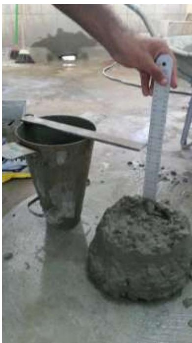
**Figura 3.1 – Ensaio de abatimento pelo método do tronco de cone.**
