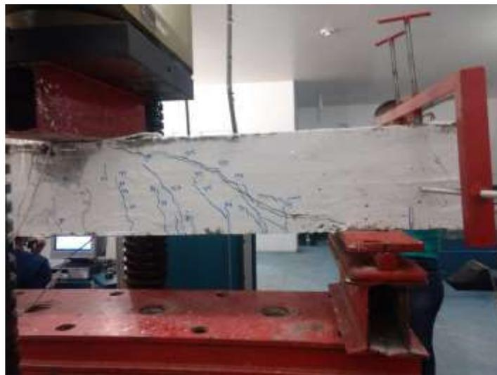
c) Viga após o ensaio
