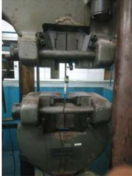
Figura 3.7 – Ensaio de caracterização do aço.
