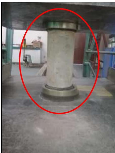
**Figura 3.4 – Corpo de prova no momento do ensaio de compressão.**
