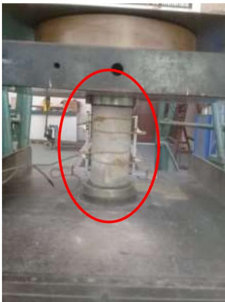
**Figura 3.6 – Corpo de prova no momento do ensaio de módulo.**
