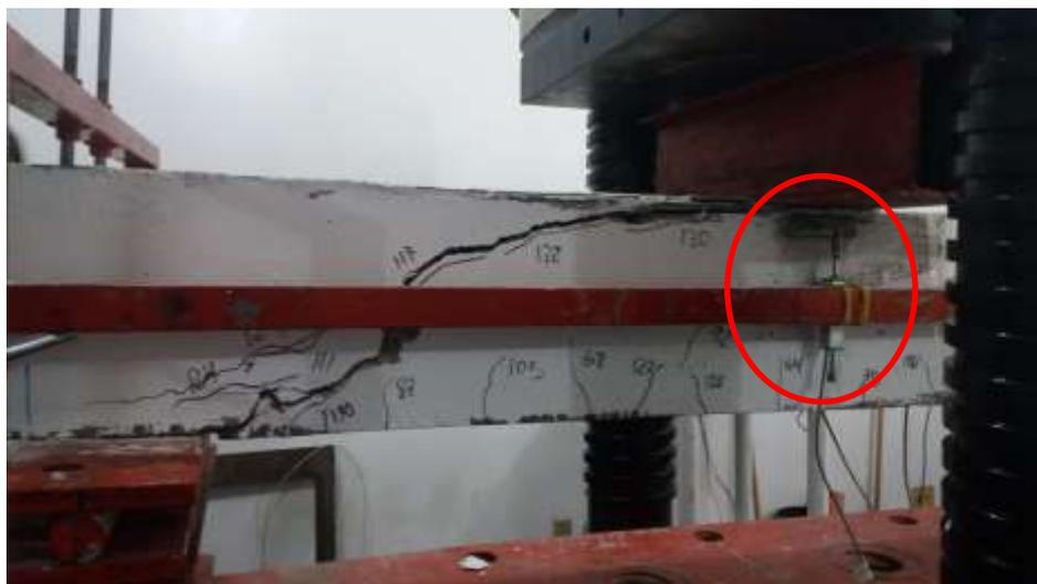
**Figura 3.17 – Posicionamento do potenciômetro durante o ensaio do elemento.**
