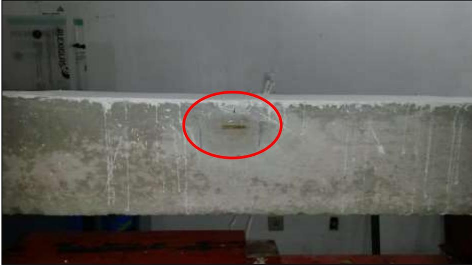
**Figura 3.15 – *Strain Gage* externo para concreto colado na face da viga.**
