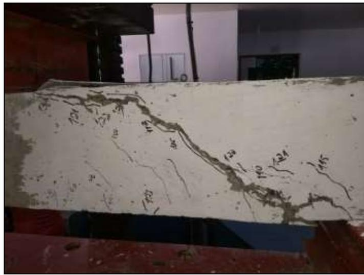
c) Viga após o ensaio
