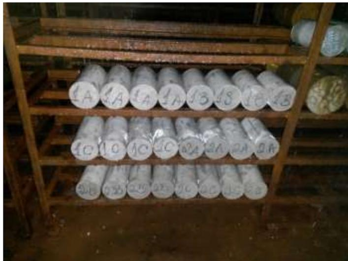
**Figura 3.3 – Corpos de prova em câmara úmida para realização da cura.**
