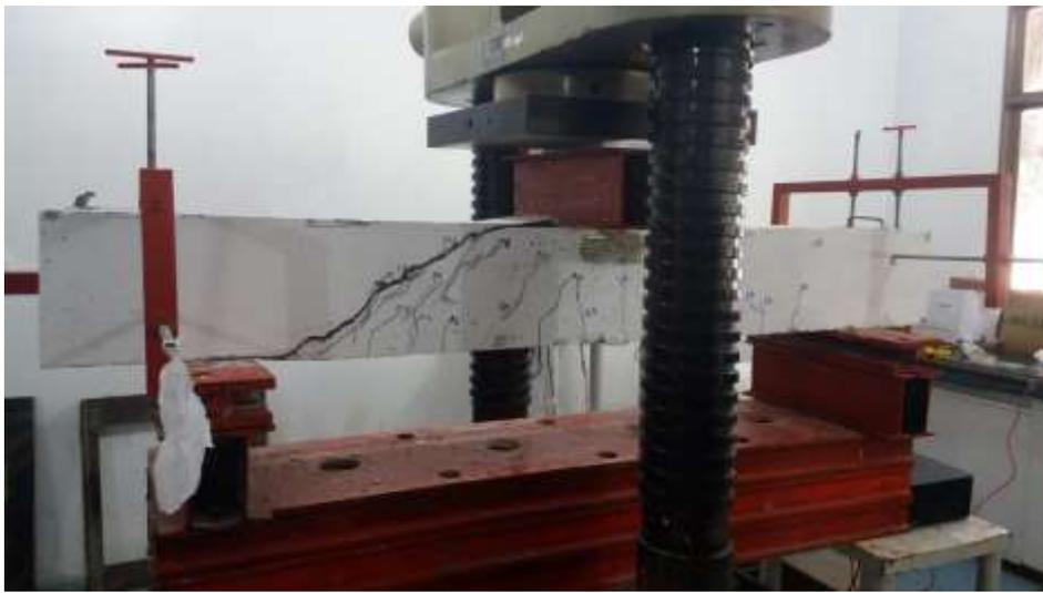
b) Viga após o ensaio
