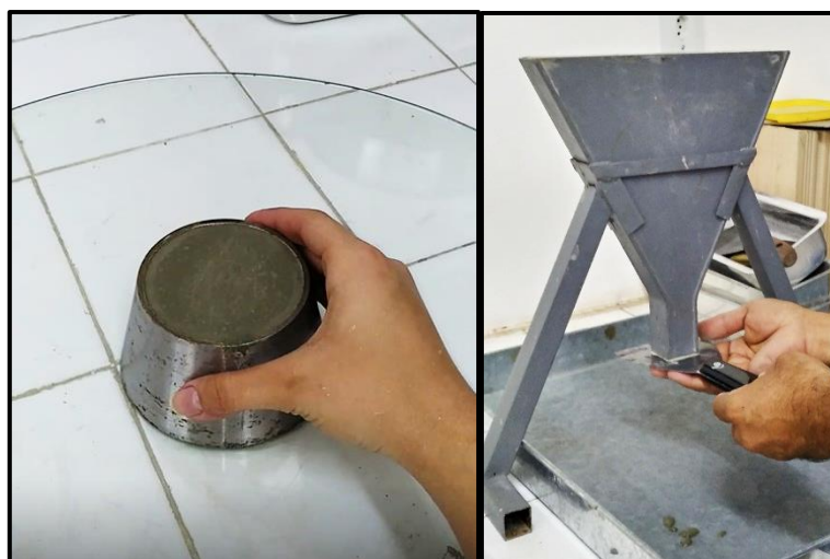
Figura 3.9 – Momento dos ensaios com mini-slump, à esquerda, e com mini funil-V, à direita (Fonte: a autora).
