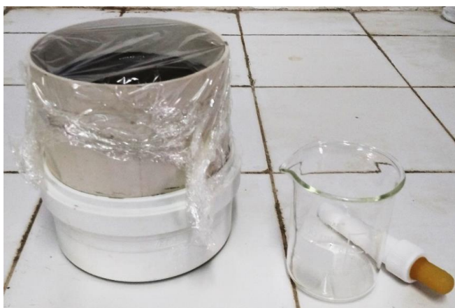
Figura 3.10 – Ensaio de exsudação da argamassa formulada (Fonte: a autora).
