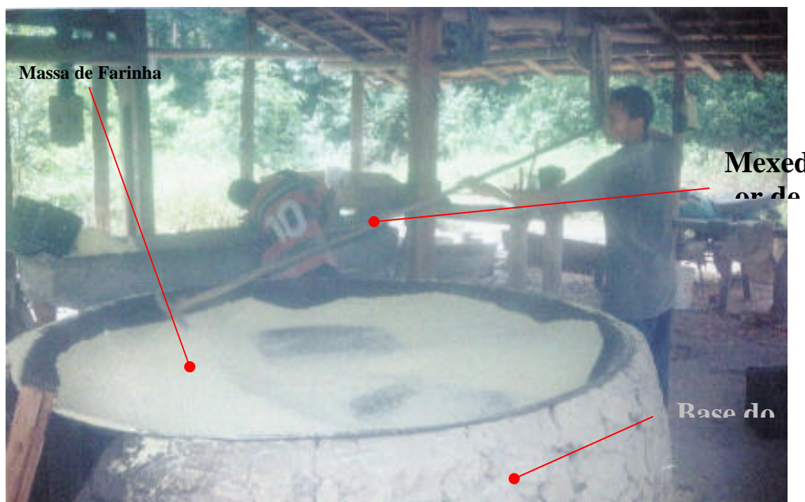
Figura 16 – Interior de uma casa de farinha em funcionamento na Comunidade Jericó, Garrafão do Norte, Pará. Destaque para o tacho, onde a farinha está sendo assada, para o mexedor de farinha feito a partir de uma espécie conhecida como Cabo de Rodo ( Guatteria poeppigiana Mart.), e para a base do forno feito com madeira da capoeira e barro.
