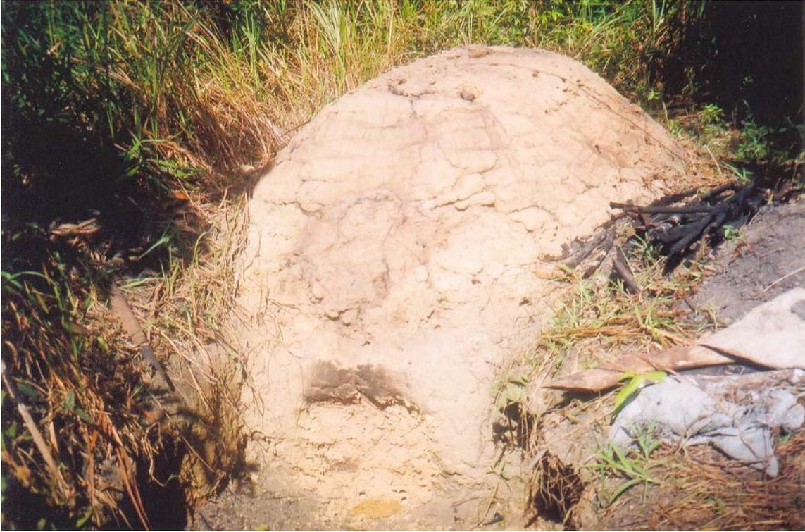
Figura 9. Horno de carbón lleno del material en fase de enfriamiento.
