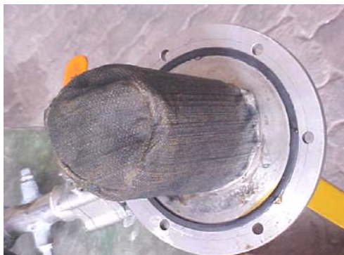
Figura 6-17 - presença de umidade no filtro
