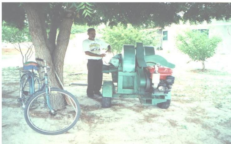
Figura 28 – Máquina Desfibradora em Teste na APAEB
