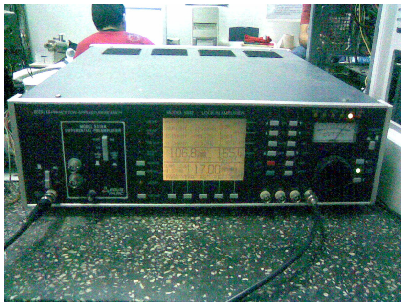
Fig. 3.13 – Lock-in amplifier usado para medidas de difusividade térmica.
