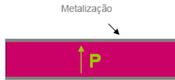
Fig. 2.4 - Esquema do sensor piroelétrico com superfícies metalizadas.
