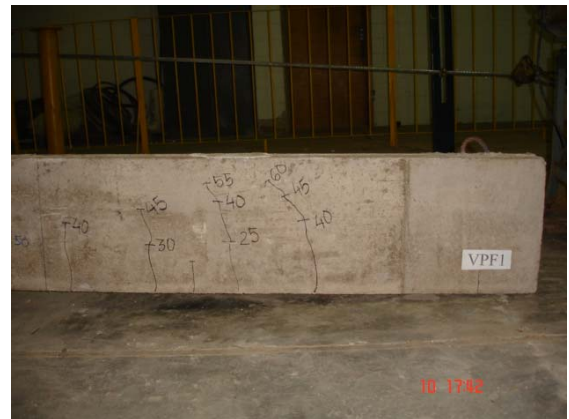
Figura 4.34 – Padrão de fissuração da viga VPF1 (ruína por flexão)
