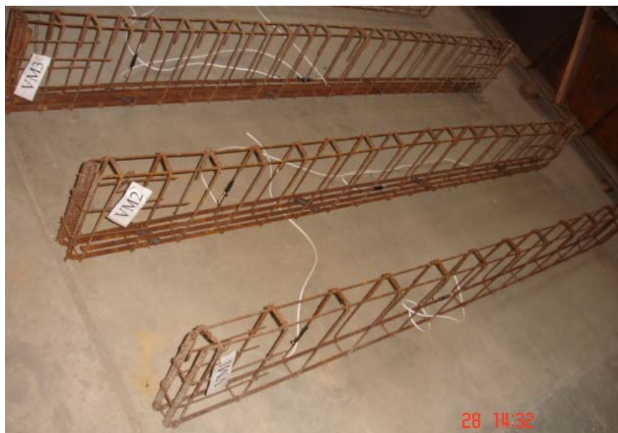
Figura 3.21 – Detalhes da armadura das vigas maciças
