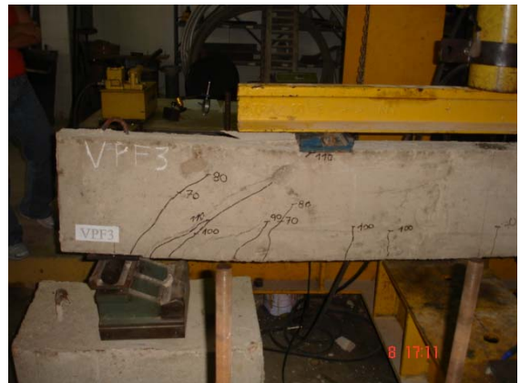
Figura 4.36 – Padrão de fissuração da viga VPF3 (ruína por flexão)
