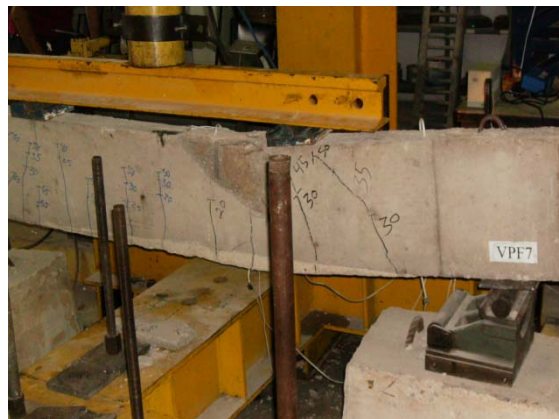
Figura 4.40 – Padrão de fissuração da viga VPF7 (ruína por flexão)
