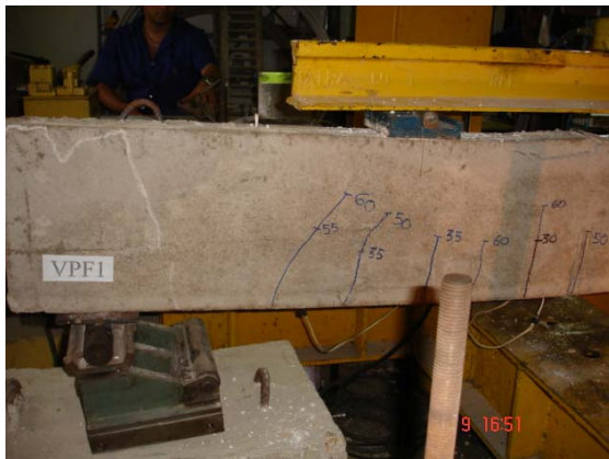
Figura 4.34 – Padrão de fissuração da viga VPF1 (ruína por flexão)
