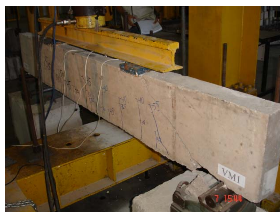
Figura 4.31 – Padrão de fissuração da viga VM1 (ruína por cisalhamento)
