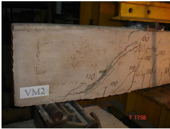
Figura 4.32 – Padrão de fissuração da viga VM2 (ruína por cisalhamento)
