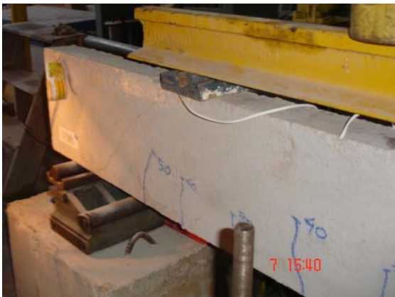
Figura 4.37 – Padrão de fissuração da viga VPF4 (ruína por flexão)
