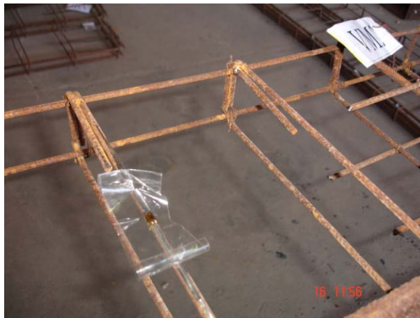
Figura 3.25 – Posição dos extensômetro nos estribos
