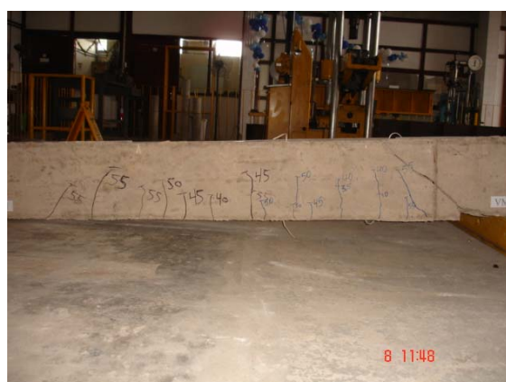
Figura 4.31 – Padrão de fissuração da viga VM1 (ruína por cisalhamento)
