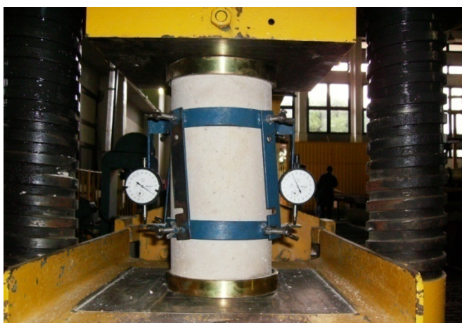
Figura 4.3 – Ensaio de módulo de elasticidade do concreto
