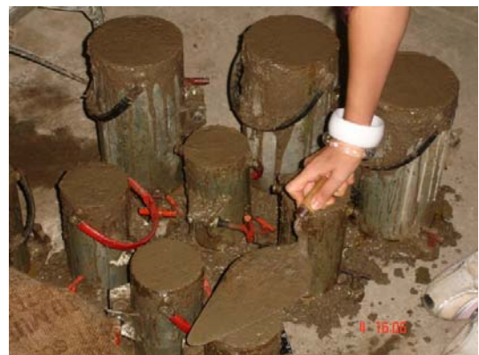
Figura 3.36 – Moldagem de corpos-de-prova do concreto
