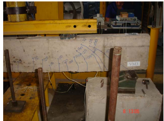
Figura 4.33 – Padrão de fissuração da viga VM3 (ruína por cisalhamento)
