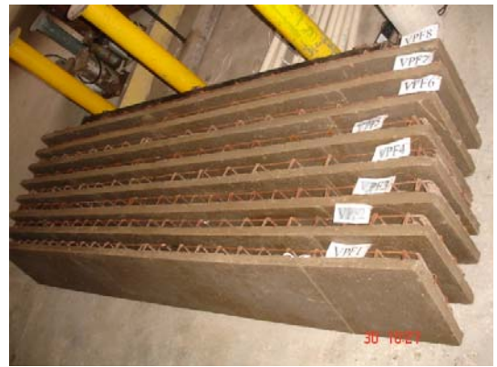
Figura 3.30 – Cura do concreto e placas desformadas da primeira etapa (lateral 1)
