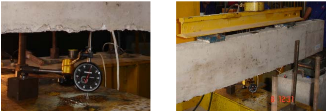
Figura 3.17 – Posicionamento dos deflectômetros
