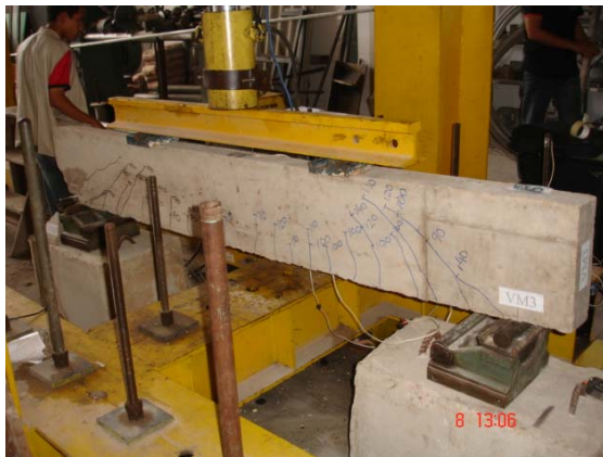
Figura 4.33 – Padrão de fissuração da viga VM3 (ruína por cisalhamento)
