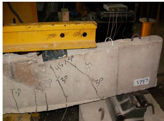
Figura 4.40 – Padrão de fissuração da viga VPF7 (ruína por flexão)
