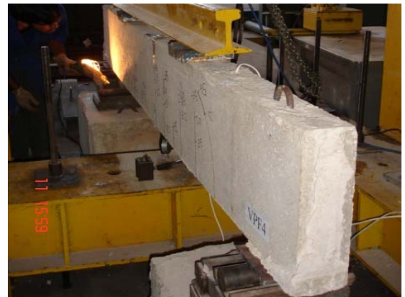
Figura 4.37 – Padrão de fissuração da viga VPF4 (ruína por flexão)
