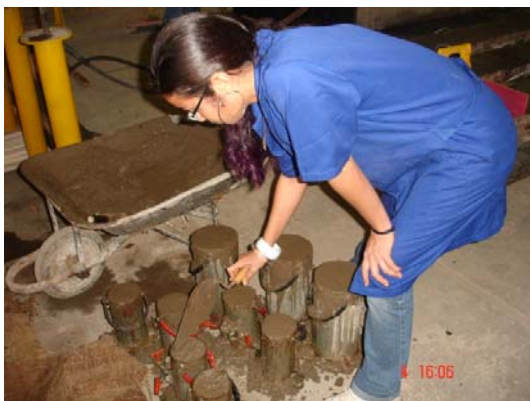
Figura 3.36 – Moldagem de corpos-de-prova do concreto
