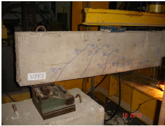
Figura 4.35 – Padrão de fissuração da viga VPF2 (ruína por flexão)
