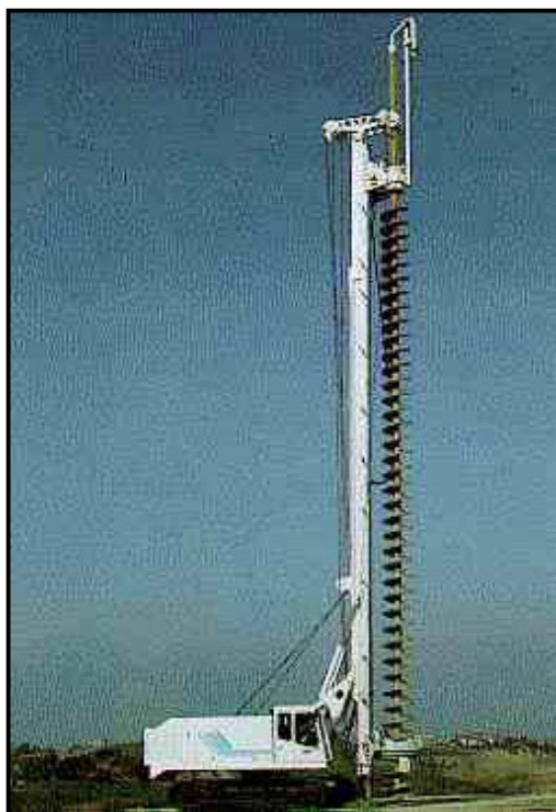
Figura 4.17 – Exemplo de execução de estaca tipo hélice contínua Fonte: FUNDESP – Catálogo de Produtos (2001)
