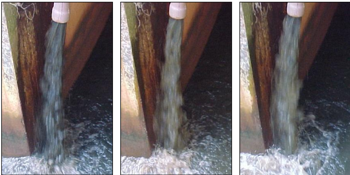
Fotografia 40, 41 e 42 - Descarga do lodo na abertura da válvula do sistema auxiliar, no 5º e 10º minuto – Fase 2
