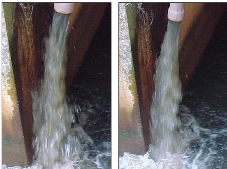
Fotografia 43 e 44 - Descarga do lodo do sistema auxiliar no 15º e 20º minuto – Fase 2
