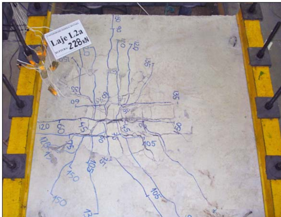
Figura 4.34 – Mapa de fissuração da laje L2a
