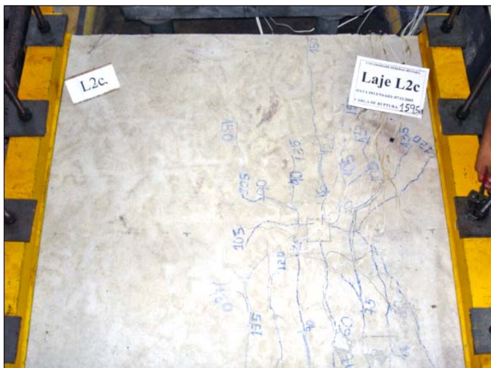
Figura 4.36 – Mapa de fissuração da laje L2c
