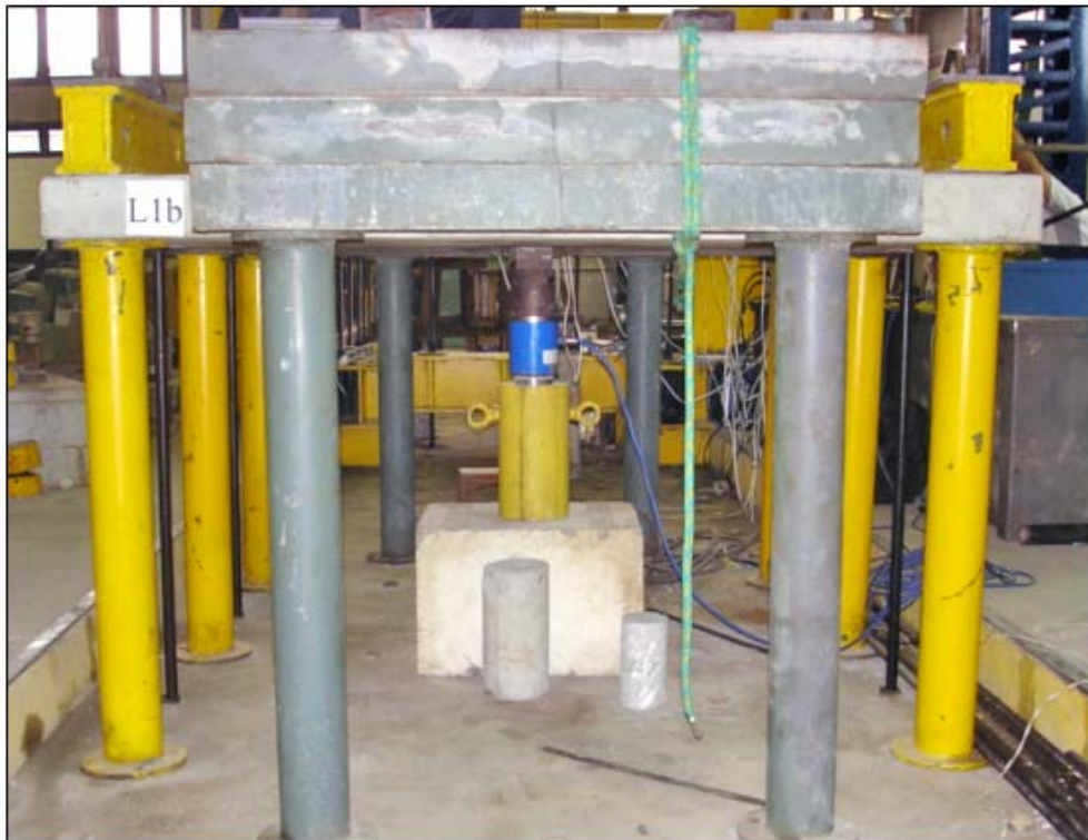
Figura 3.14 – Posicionamento do cilindro no ensaio da laje L1b
