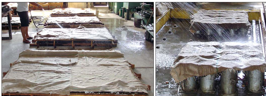
Figura 3.22 – Processo de cura das lajes e dos corpos de prova
