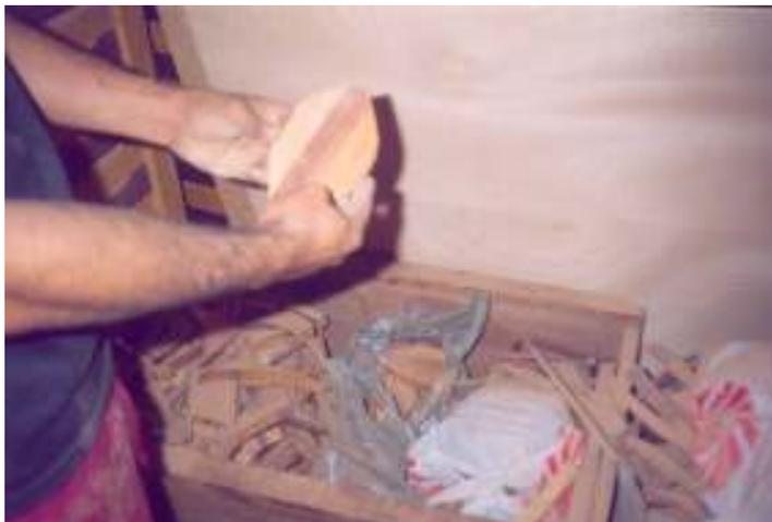
Foto 13- Resíduos de madeiras da produção de móveis guardados em uma caixa para serem reaproveitados por meio de colagem. Marcos mostra através da união de duas peças a possível criação de um novo pequeno objeto. Shirley Monteiro em: 07/2004
