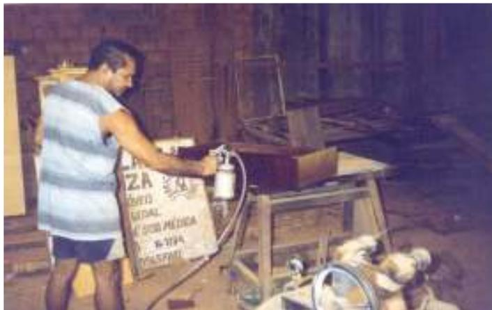
Foto 18 – Seu Sebastião com a pistola de ar comprimido que é utilizada para pintar a fruteira. Nesta foto ele demonstra a maneira de usá-la em outro objeto. Shirley Monteiro em 18/2004.
