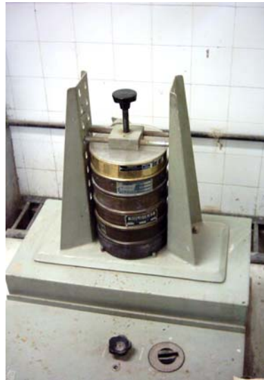
Figura 11 – Peneiradeira mecânica utilizada para caracterização granulométrica da areia.
