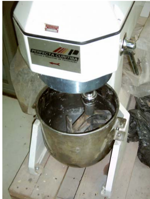
Figura 32 – Argamassadeira utilizada no programa experimental.
