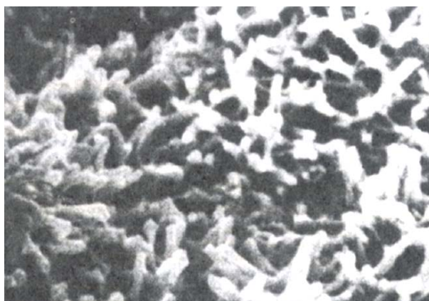
Figura 05 - Microscopia eletrônica de varredura (mev) de amostra fraturada de pasta de cimento Portland com 3 dias de idade – formação dos cristais de C – S – H, pouco cristalinos e de morfologia fibrosa (fonte: METHA & MONTEIRO, 1994)
