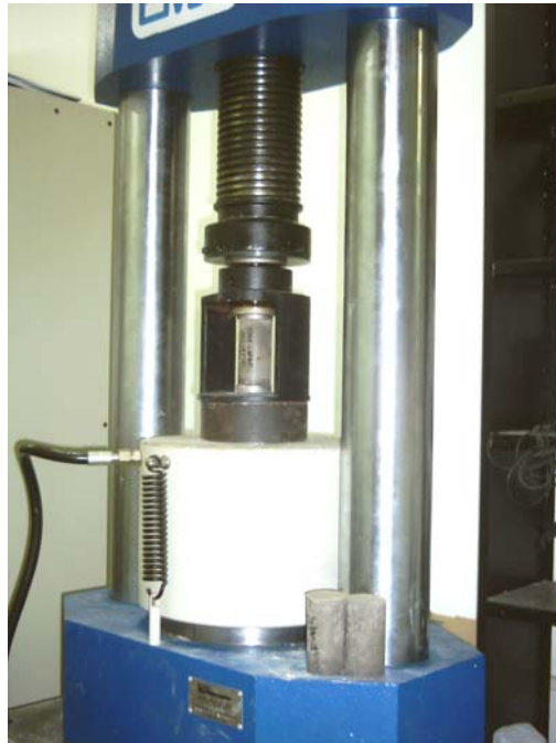
Figura 34 – Prensa EMIC SSH30, com célula Trd 30 utilizada nos testes destrutivos do programa experimental.
