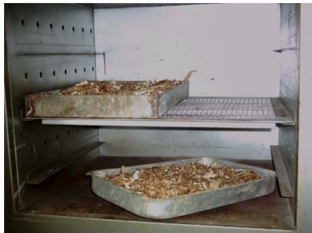
Figura 20 – Retirada do resíduo de madeira da estufa após secagem sob temperatura controlada
