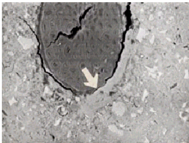
Figura 10 – Imagem por elétrons retroespalhados em compósito de cimento Portland e fibra de coco aos 28 dias. A seta indica a zona de transição fissurada. (Fonte: SAVASTANO, 1992).
