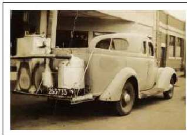
Figura 3.5- Veículo movido à gás pobre usado durante a Segunda Guerra.
