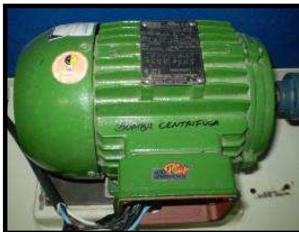
Figura 4.3 – Motor elétrico de indução trifásico.
