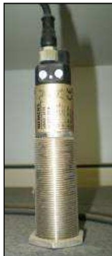
Figura 4.11 – Sensor de nível SIEMENS SONAR BERO
