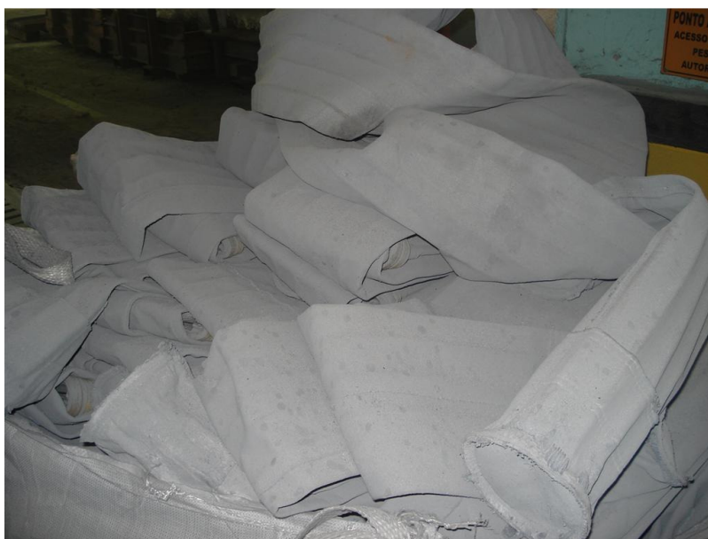
Figura 3.10 – Filtros de manga desgastados
