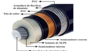
Fig. 6. Cabo coaxial de alta tensão.
