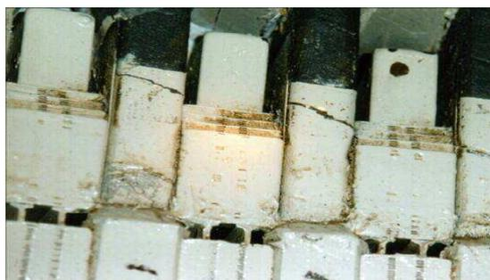
**Figura 3.15** - Foto de um exemplo de comportamento de ruptura por causa do ciclo de carga
