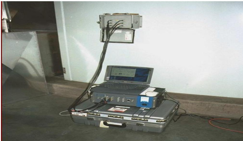
**Figura 4.3** – Foto do PDA-IV com os três pares de acopladores conectados
