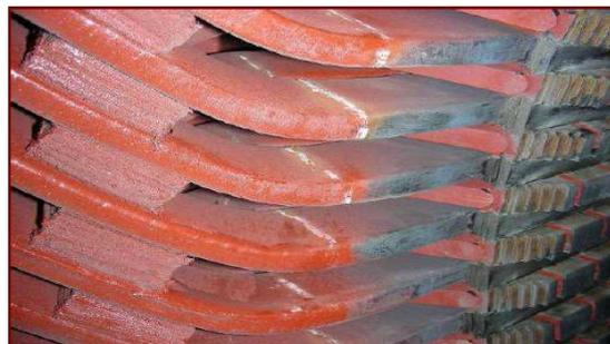
**Figura 3.8** – Falha na cobertura semicondutora.
