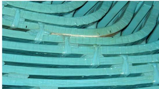
**Figura 3.12** – Foto de um exemplo de espaçamento inadequado
