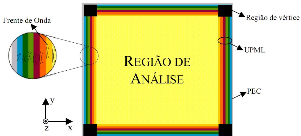
FIGURA 3.8: Esquema geométrico para truncagem da malha, tempo e espaço, usando a UPML em um plano [23].
