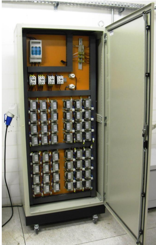
Figura 2.9: Painel dos circuitos indutivos que simulam a linha de transmissão.
