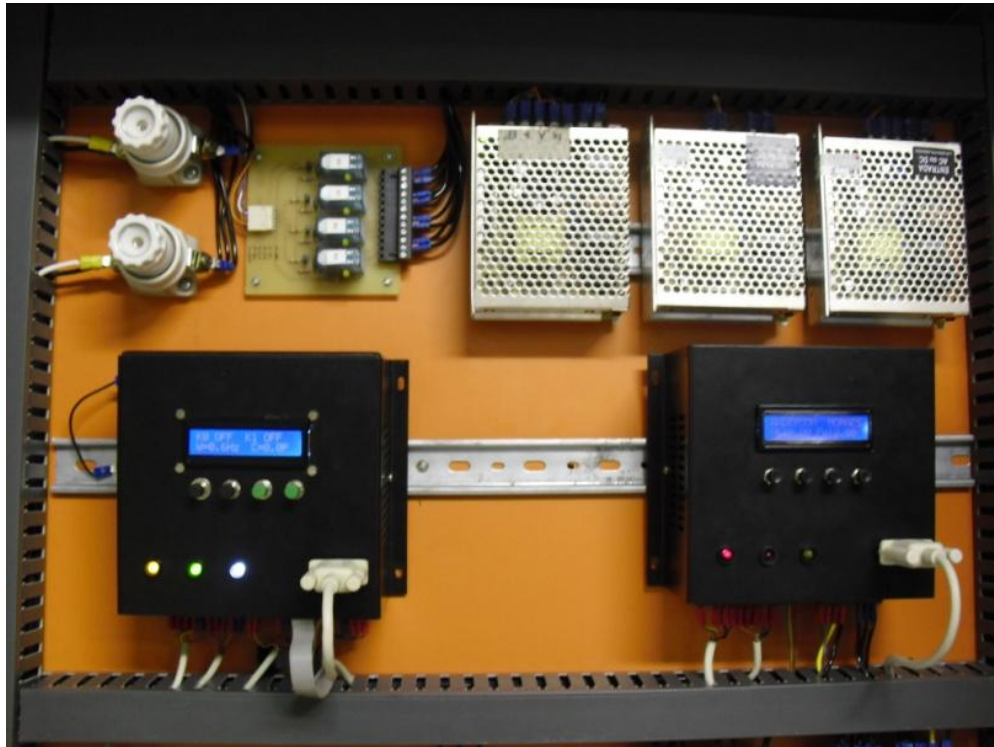
Figura 2.7: Sistemas eletrônicos de regulação de velocidade e tensão da micromáquina.
