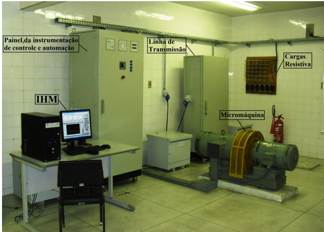
Figura 2.1: Laboratório de Controle de Sistemas de Potência destacando o Sistema de Geração em Escala Reduzida.
