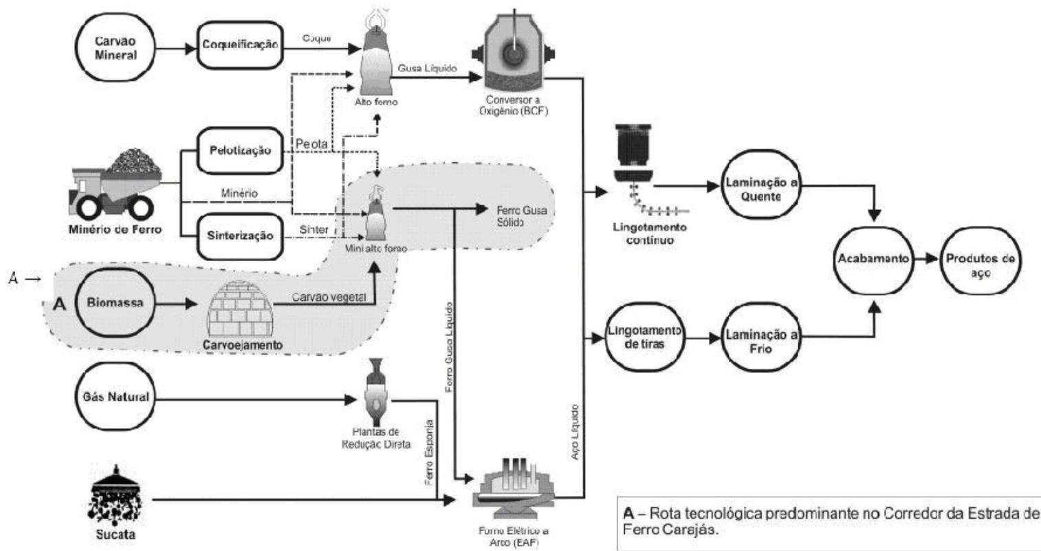
**Figura 2:** Representação esquemática das principais rotas tecnológicas utilizadas para a produção de aço.
