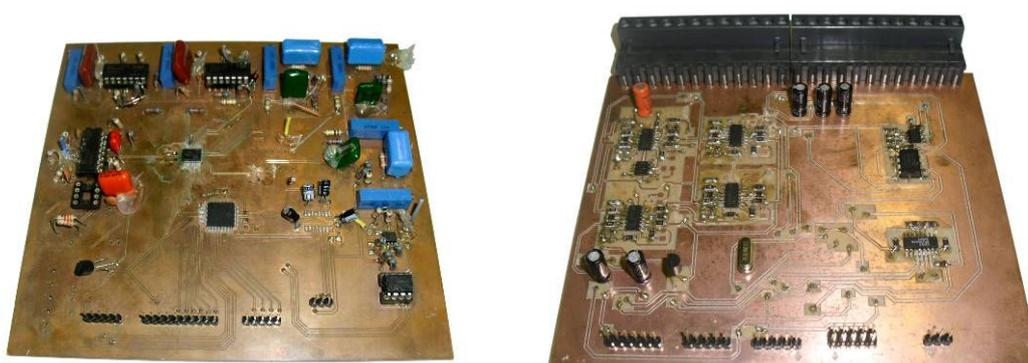
**Figura 6.18 - Protótipos da placa de circuito impresso do ESP digital.**
