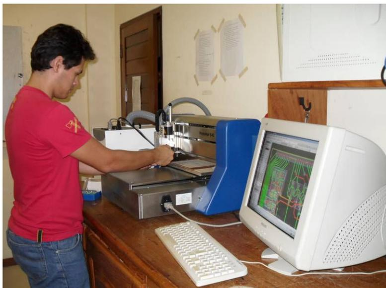
**Figura 6.17 - Processo de prototipagem de PCI.**
