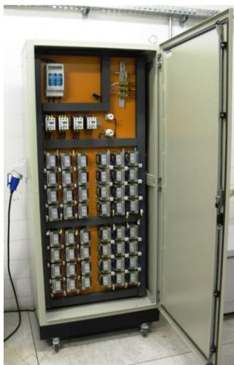
**Figura 7.4: Painel dos circuitos indutivos que simulam a linha de transmissão.**
