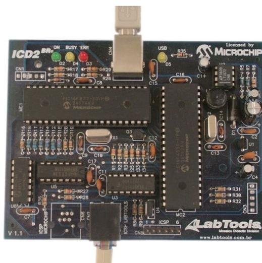
**Figura 6.20 - Programador e depurador ICD2**
