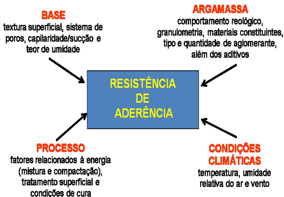
Figura 2.9 - Fatores que influenciam na resistência de aderência de revestimentos.
