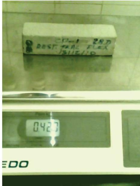
Figura C.3 – Execução do ensaio de densidade de massa aparente.
