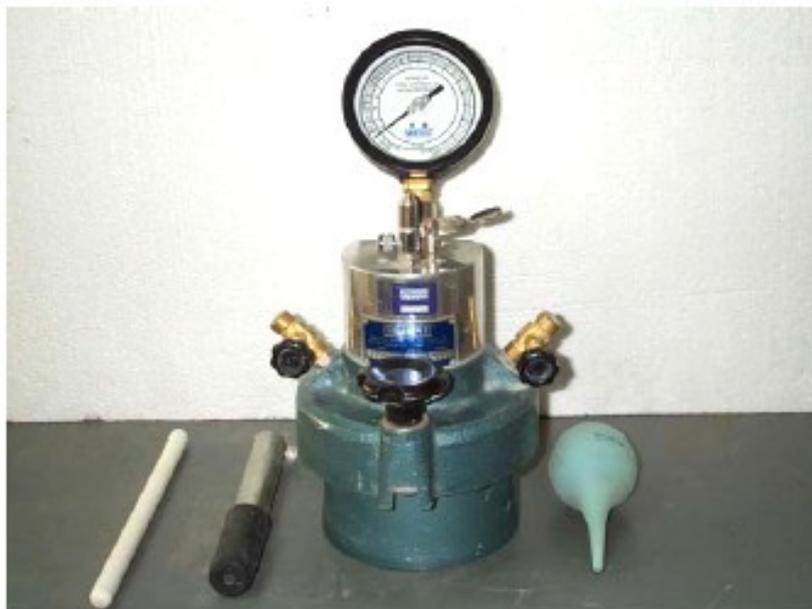
Figura B.3 – Aparelho utilizado para medir teor de ar incorporado, tipo B.
