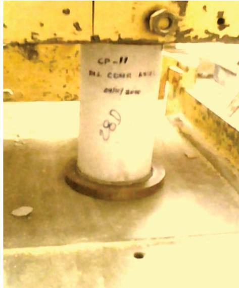
Figura C.1 – Ensaio de resistência à compressão axial aos 28 dias.
