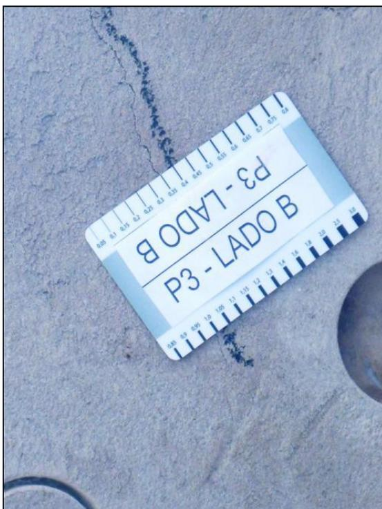
Figura 3.5- Leitura da abertura de fissuras com a utilização de um fissurômetro.
