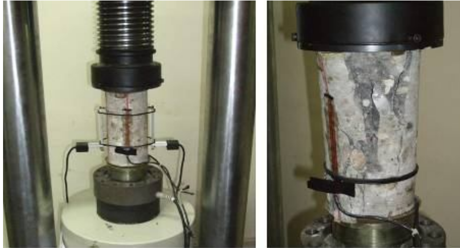
Figura 26 – Aspecto da amostra durante o ensaio de módulo de elasticidade e compressão axial (TEIXEIRA, 2009)
