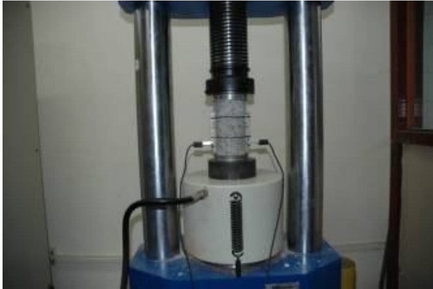
Figura 131 –Extensômetros tipo “clip-gage” fixado no corpo-de-prova
