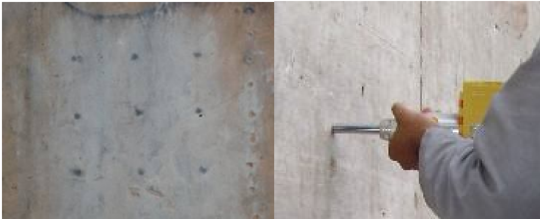
Figura 20 – Ensaio de esclerometria no Encontro E1 (BRANCO et al. , 2010)
