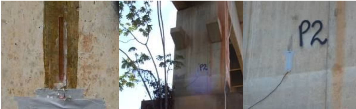
Figura 44 –Extensômetria do pilar P2 (BRANCO et al. ,2010)
