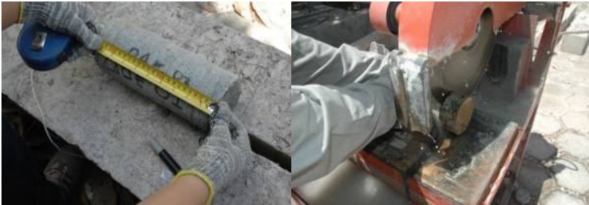
Figura 74 – Processo de marcação do testemunho e corte das faces irregulares
