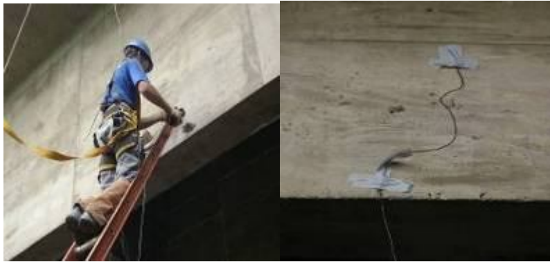
Figura 89 – Extensometria da viga longarina
