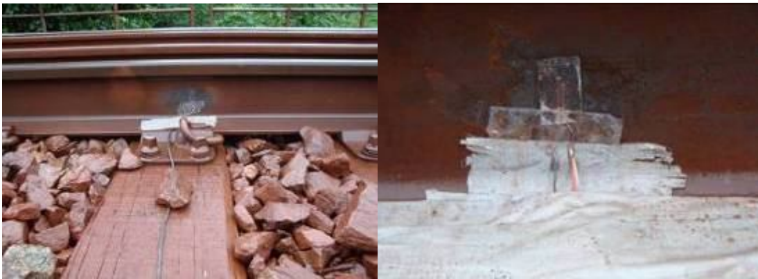
Figura 91 – Posição dos extensômetros sobre: a) o trilho TE1; b) o trilho TE2
