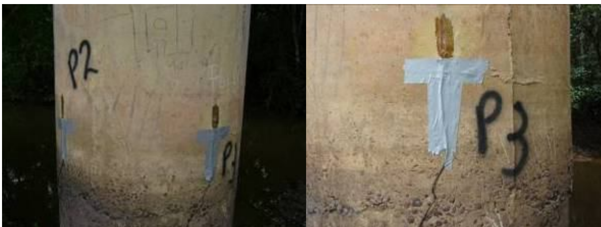
Figura 84 – Extensometria no tubulão T7
