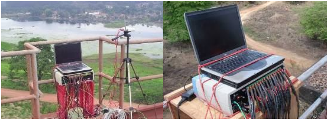
Figura 31 – Sistema de aquisição de dados utilizado nas monitorações (TEIXEIRA, 2009)
