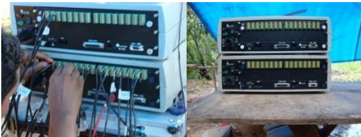
Figura 94 – Sistema de aquisição utilizado nos ensaios de vibração e deformação
