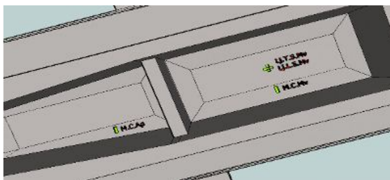
Figura 88 – Posição dos extensômetros na parte inferior do tabuleiro
