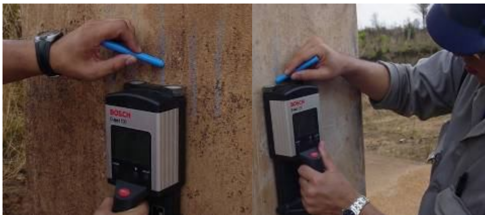
Figura 17 – Ensaios de pacometria (TEIXEIRA, 2009)
