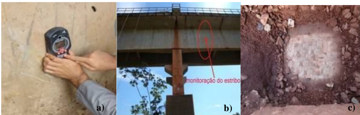
Figura 18 – a) Pacometria do pilar P2; b) longarina; c) tabuleiro (BRANCO et al. , 2010)
