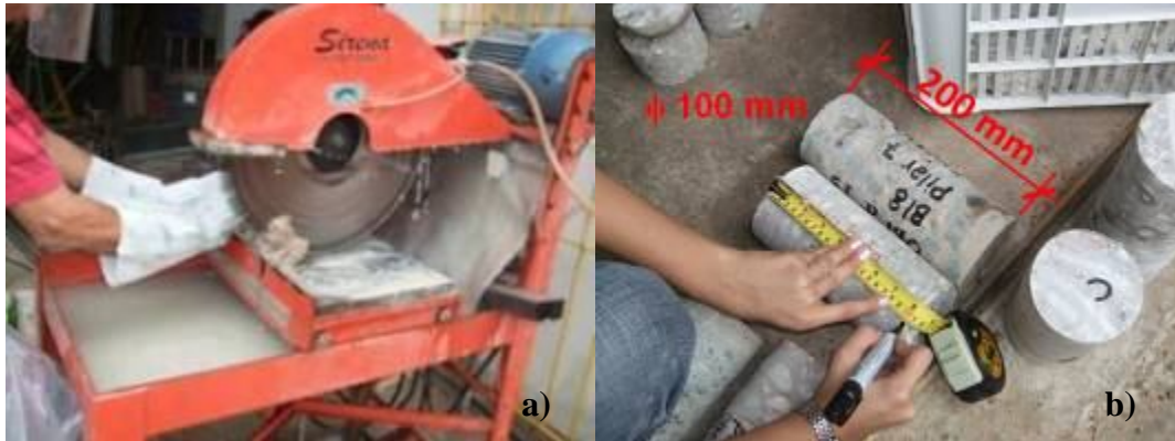
Figura 25 – Padronização das dimensões dos testemunhos (TEIXEIRA, 2009)
