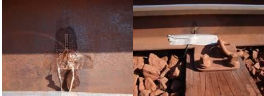
Figura 42 –Extensometria nos trilhos (BRANCO et al. ,2010)
