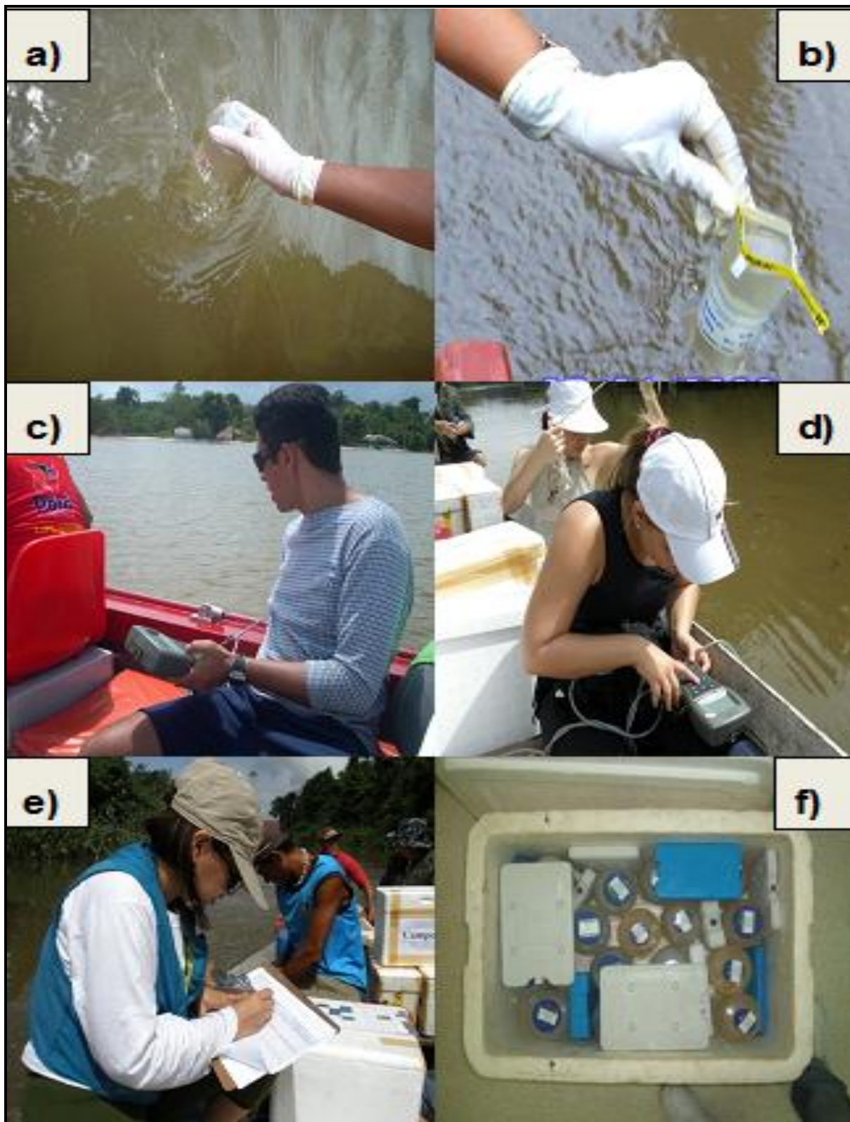
Figura 4.5: Trabalho de Campo nos rios monitorados. a) Coleta de água para análise físico-química; b) Coleta de água para exame microbiológico; c e d) Determinação “ in loco ” de variáveis físico-químicas; e) Registro de informações no momento da coleta e f) Acondicionamento e preservação de amostras em caixa isotérmica.
