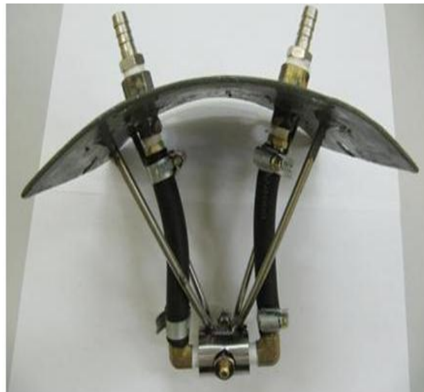
Figura 3.10 – Bico gerador de névoa.
