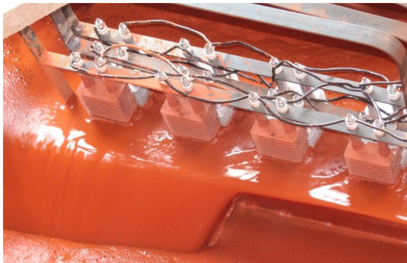
Figura 3.21 – Conjunto de resistências em contato com a suspensão de LV para elevar a temperatura inicial do experimento.
