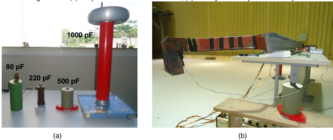
Figura 6.2 – (a) Acopladores utilizados no estudo; (b) Utilização do acoplador de 500 pF.
