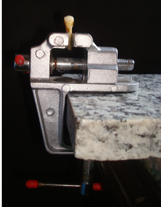
Figura 4 - Mini-torno utilizado para fixação dos dentes para as fases de cirurgia de acesso e preparo químico cirúrgico (Western – E.I.C. - Índia).
