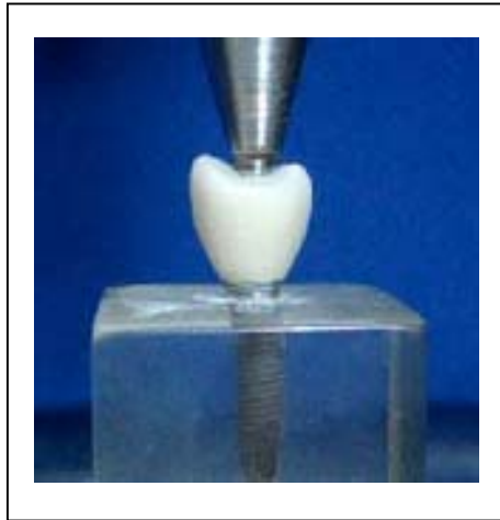
Figura 25. Fotografia do teste de compressão axial
