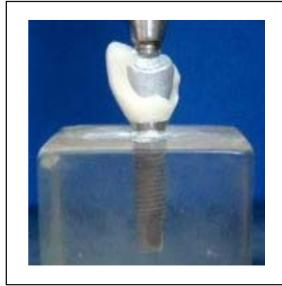
Figura 26. Padrão de fratura apresentado pelos corpos de prova com infra-estrutura em metal lisa
