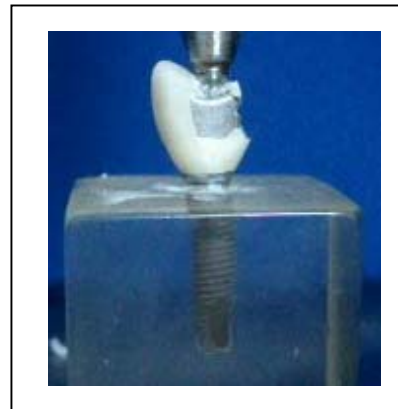
Figura 27. Padrão de fratura apresentado pelos corpos de prova com infra-estrutura em metal com retenções
