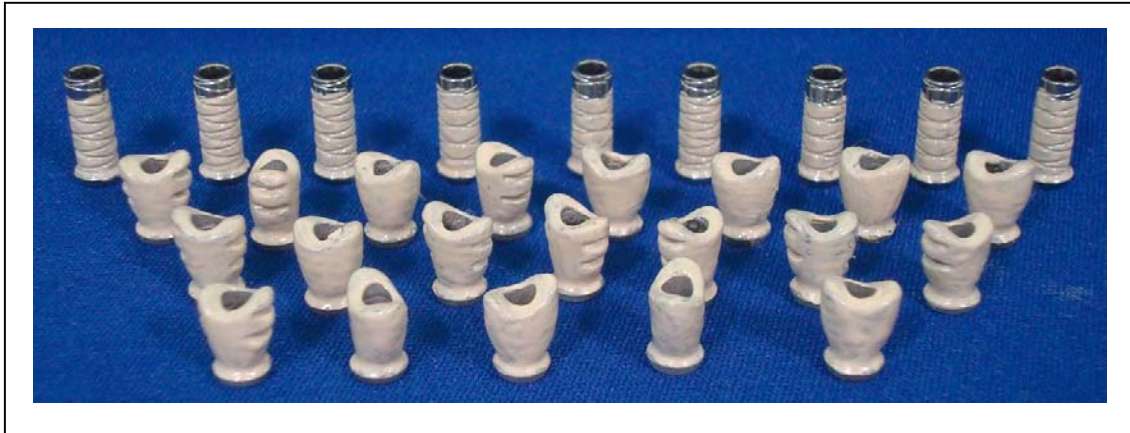
Figura 23. Infra-estruturas metálicas com a camada de opaco aplicada
