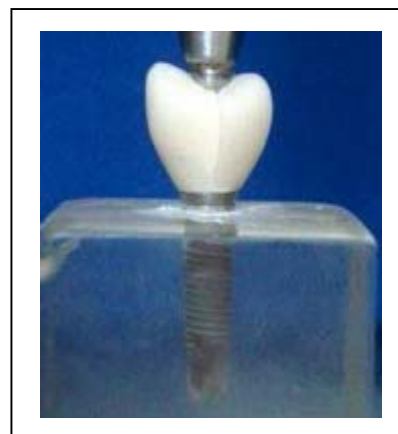
Figura 28. Padrão de fratura apresentado pelos corpos de prova com o pilar UCLA e a malha de fibras de vidro
