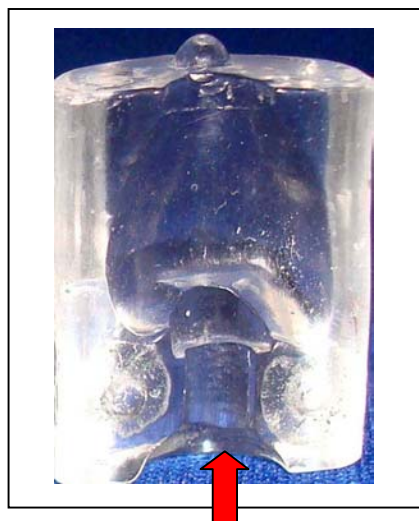
Figura 12. Orifício de acesso ao parafuso de fixação
