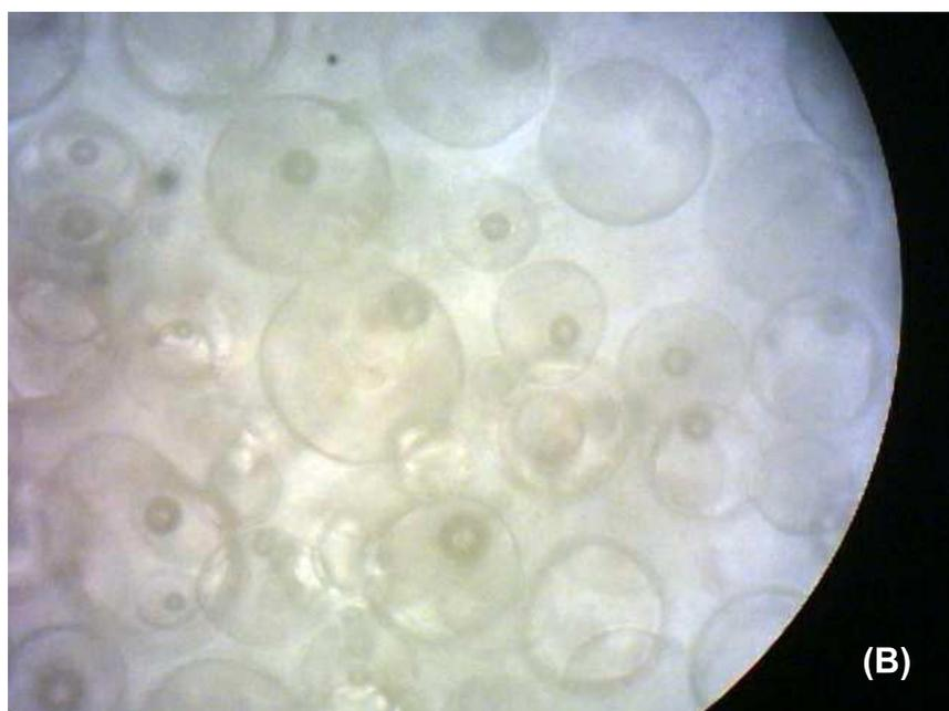
**Figura 5.4.1** - Imagem de microscópio óptico das micro-gotas de óleo de buriti no interior do poliestireno. (A) aumento de 400 x e (B) aumento de 600 x.
