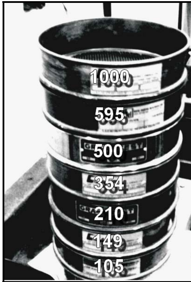
Figura 21 – Diâmetro de abertura ( \mu\text{m} ) das peneiras utilizadas na análise granulométrica. (Fonte: GTDEM-UFPA).
