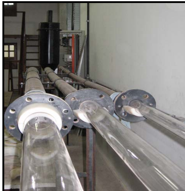
Figura 17 - Bancada Experimental. Vista à montante da tubulação de vidro (Fonte: GTDEM-UFPA).
