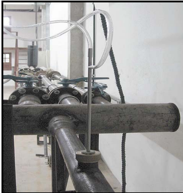
Figura 16 – Bancada Experimental. Vista à montante do duto de medição da velocidade do ar (Fonte: GTDEM – UFPA).
