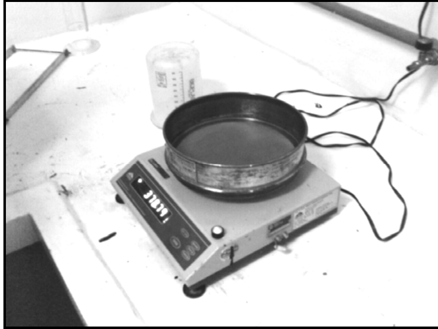
Figura 20 – Pesagem do material a ser utilizado na análise granulométrica. (Fonte: GTDEM-UFPA).
