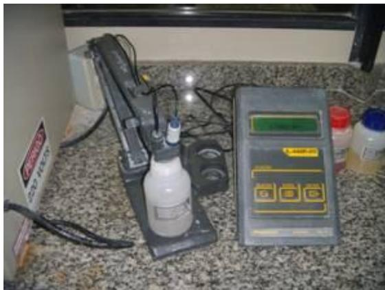
Figura 12 - Analisador de pH – Phmetro DIGIMED, Modelo DM-20
