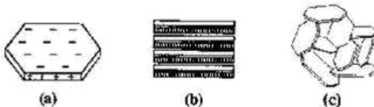
Figura 20 – Representação esquemática da Estrutura do cristal de caulinita. (a) partícula isolada, (b) estrutura lamelar agregada face a face e (c) estrutura tridimensional, provenientes da interação das partículas por forças de van der Waals (Li & Eriksson, 1994).
