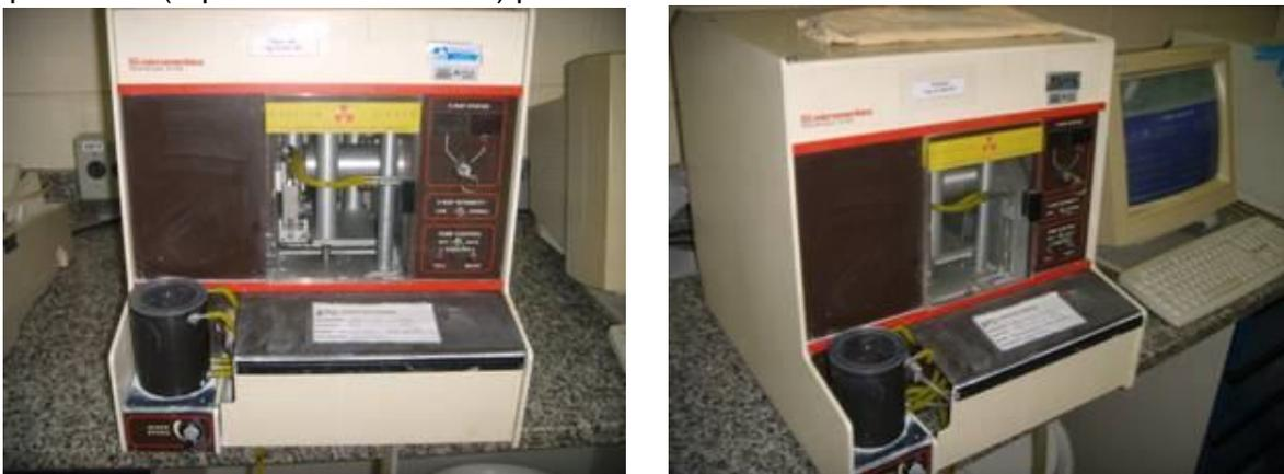
Figura 11 - Analisador de tamanho de partículas (Sedígrafo) – Marca MICROMERITICS - SEDIGRAPH 5100
