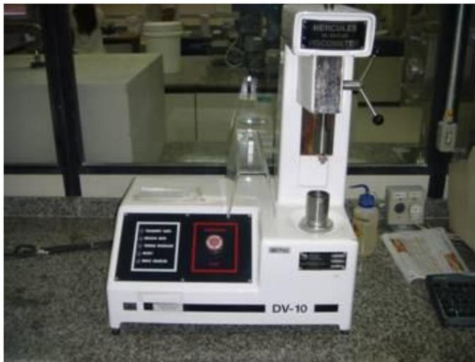
Figura 13 - Viscosímetro HÉRCULES HI-SHEAR, Modelo DV-10
