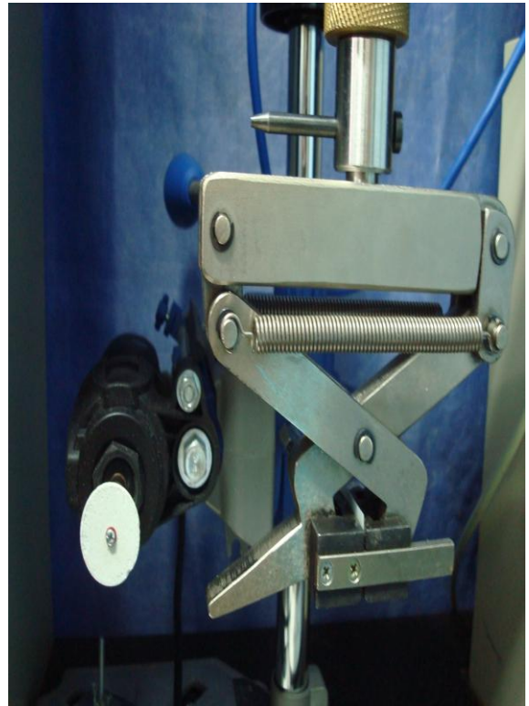
Figura 4.6 – Disco cerâmico acoplado ao dispositivo.
