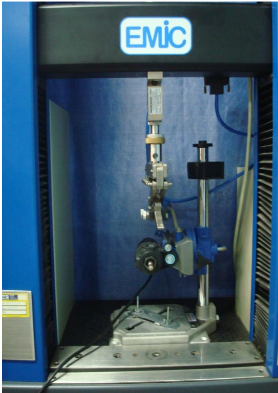
Figura 4.5—Máquina Universal de ensaios mecânicos com o dispositivo adicionado.
