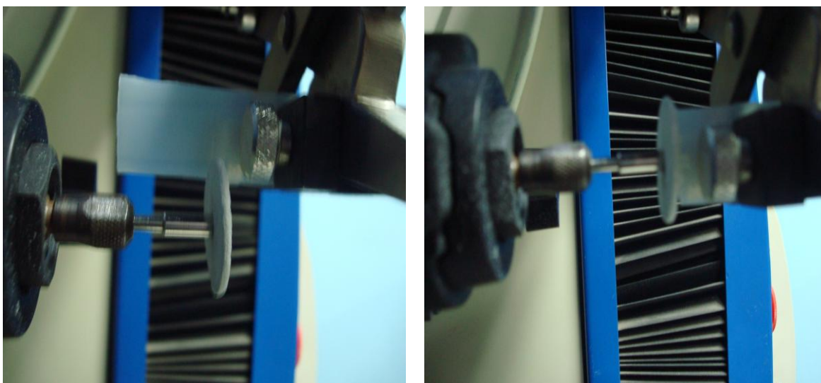
Figura 4.12 – Ensaio de corte de materiais poliméricos com disco cerâmico.
