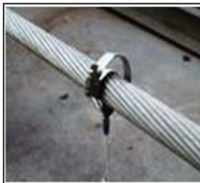
Figura 6.16 - Fixação do acelerômetro.
