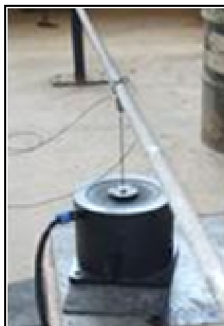
Figura 6.17 - Fixação do conjunto excitador.
