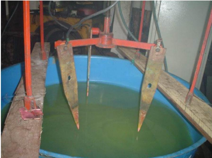
Figura 11 – Configuração de carga trifásica
