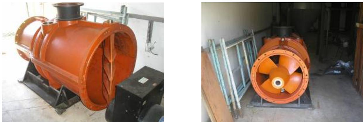
**Figura 12 – Turbina Hidráulica tipo hélice – Laboratório de Turbomáquinas da UFPA.**
