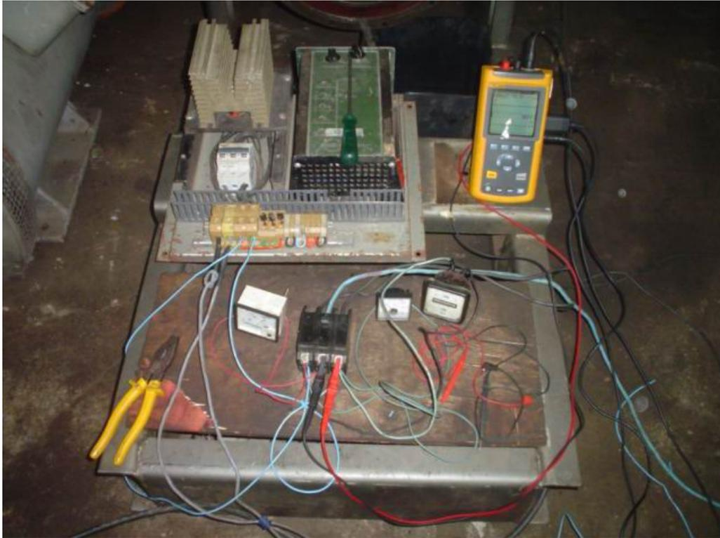
Figura 2 – Conjunto regulador de tensão e Fluke 43B
