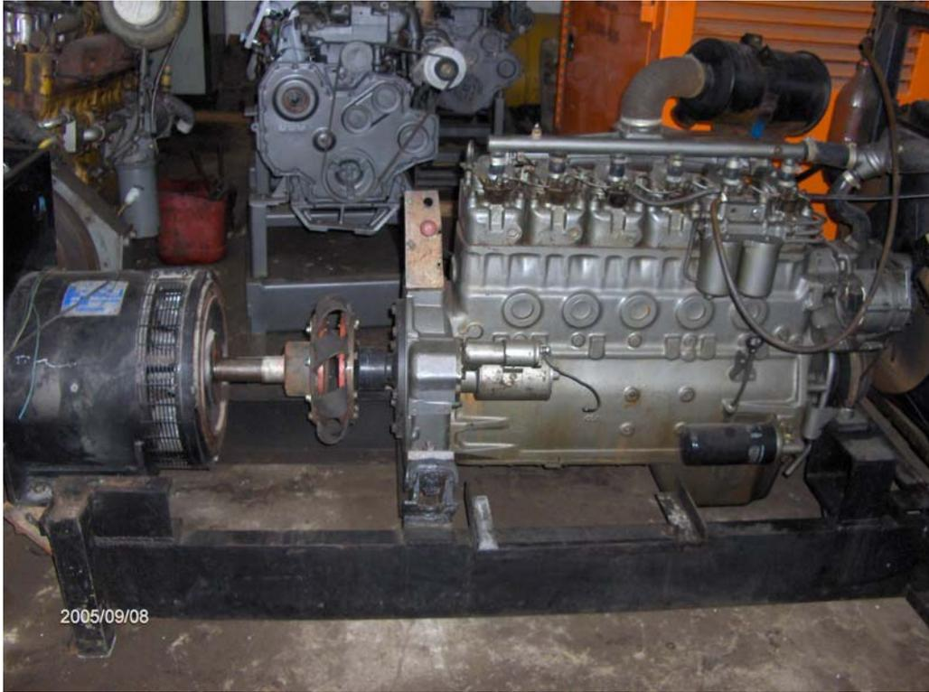
Figura 3 – Gerador e motor diesel
