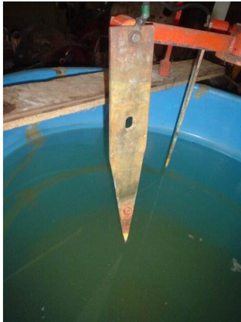
Figura 9 – Ponta de cobre da carga eletrolítica
