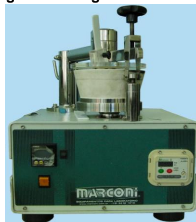
Figura 4b – Digestor de Fibras
