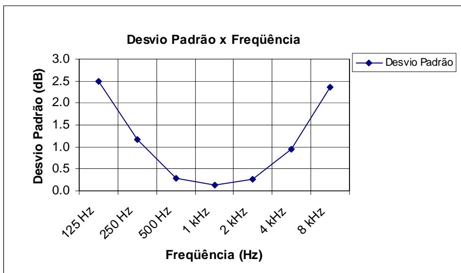
Figura 6.7 – Desvio Padrão das divisórias de fibra de aço.
