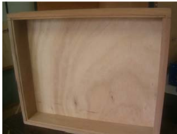
Figura 4.10 – Instalação do Compensado de 4 mm.
