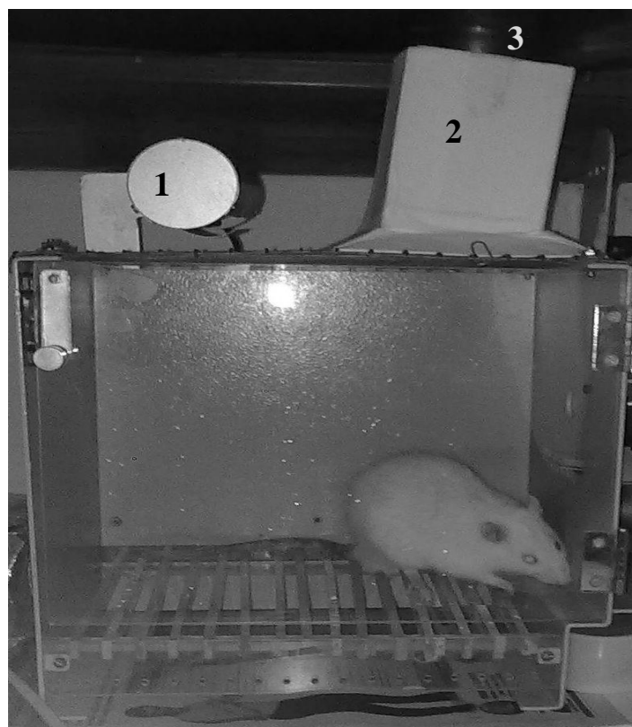
Figura 3. Caixa de Condicionamento Operante Adaptada composta por: 1. Lâmpada Incandescente; 2. Suporte e 3. Secador de Cabelo.
