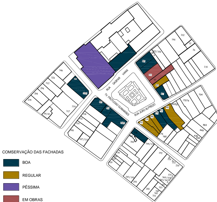
Fig. 72: Mapa do estado de conservação das fachadas principais. Fonte: Borges, Tatiana, 2012.
