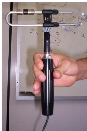
Figura 64 – Sonda de intensimetria com microfones e espaçador de 10 mm. Fonte: a autora.
