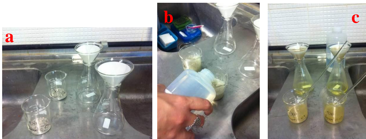
Figura 30: Imagens do ensaio de traço: (a) amostras preparadas para receber o ácido clorídrico (HCl); (b) solução HCl na proporção 1:4; (c) filtragem da amostra diluída em HCl.
