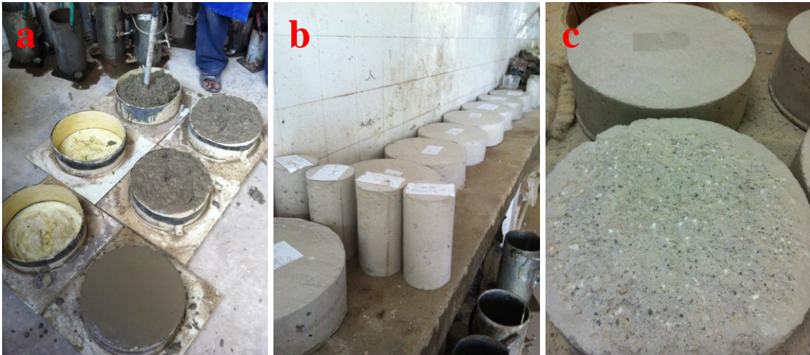
Figura 41: Produção das “bolachas de concreto”: (a) preparo das “bolachas” nas formas cilíndricas; (b) “bolachas” prontas para aplicação das argamassas e corpos de prova cilíndricos preparados para ensaio de resistência à compressão; (c) “bolachas” superfície lisa e rugosa.
