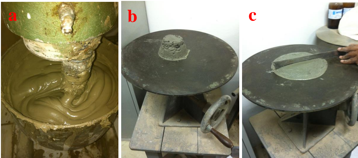
Figura 42: Produção das argamassas: (a) materiais sendo misturados na argamassadeira; (b) e (c) realização do ensaio de Determinação do índice de consistência normal da argamassa.
