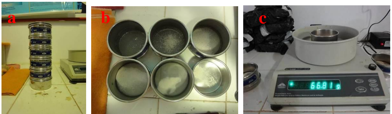
Figura 31: Imagens do ensaio de granulometria: (a) jogo de peneiras utilizada no ensaio; (b) areia retidas nas peneiras; (c) pesagem do material.
