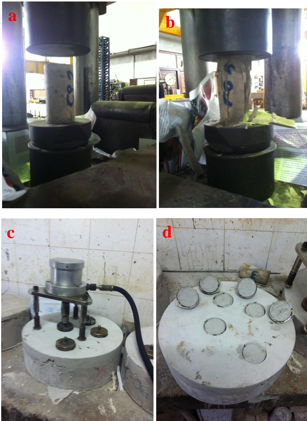
Figura 44: Caracterização física das argamassas: (a) e (b) Ensaio para Determinação da resistência à compressão; (c) e (d) Ensaio para Determinação da resistência de aderência à tração.
