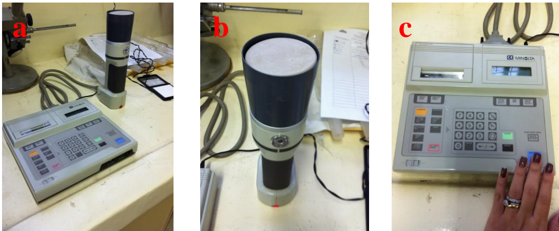
Figura 37: Ensaio de Colorimetria: (a) equipamento da marca Minolta; (b) amostra da argamassa inserida no canhão de leitura; (c) resultados exibidos no display do equipamento.
