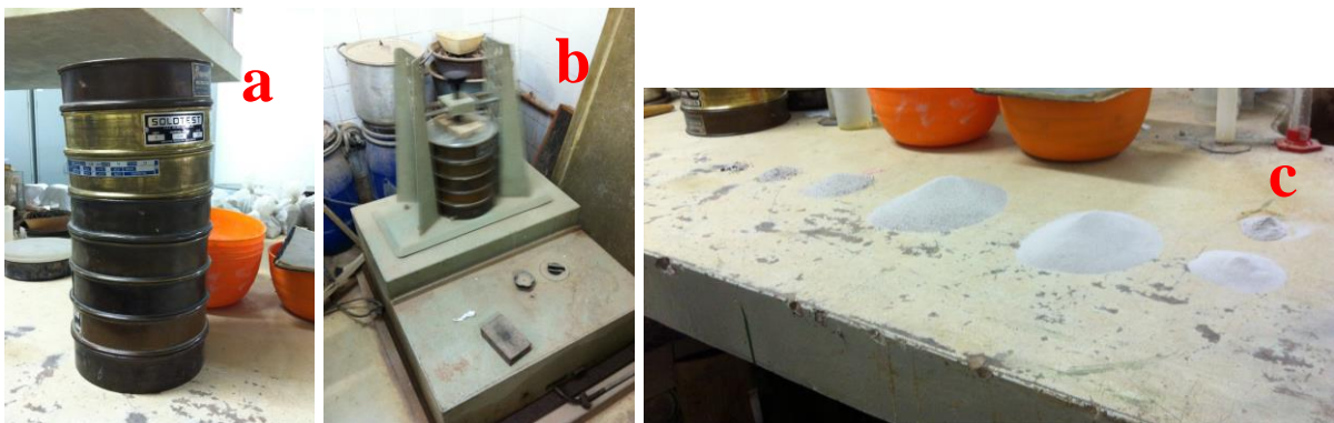
Figura 35: Caracterização da areia: (a) Jogo de peneiras; (b) agitador mecânico; (c) areia separada por módulo de finura.
