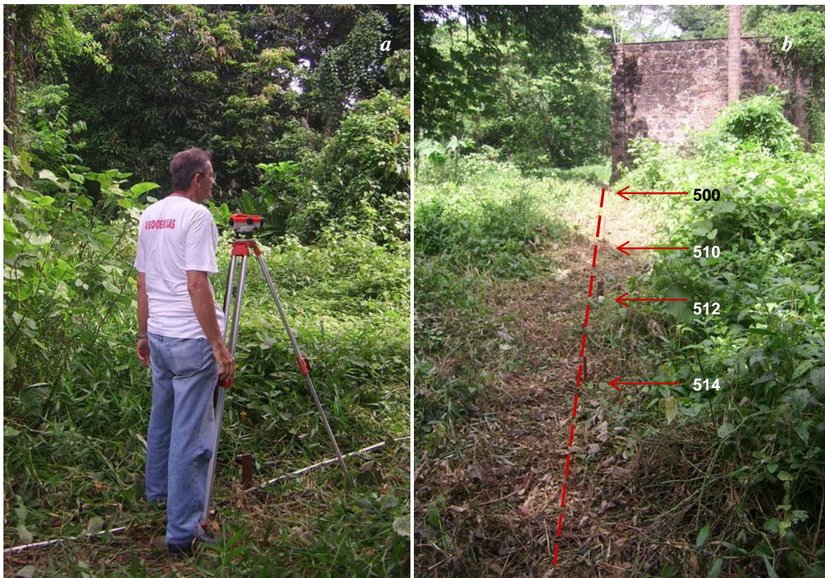
Figura 5.4 – (a) Abertura da linha de referência com auxílio de um nível, (b) linha base de referência demarcada a cada 2m por estacas (indicadas por setas).
