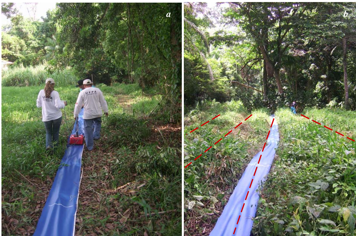
Figura 5.6 – (a) Levantamento GPR na linha 550 e (b) linha 532 coberta com material plástico e outros perfis indicados por linhas tracejadas.
