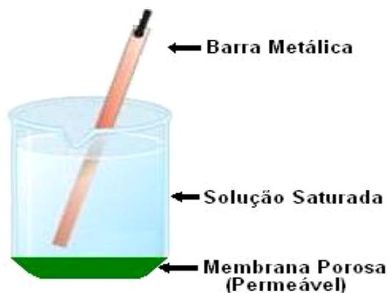
Figura 4 – Representação esquemática de um eletrodo não polarizável.
